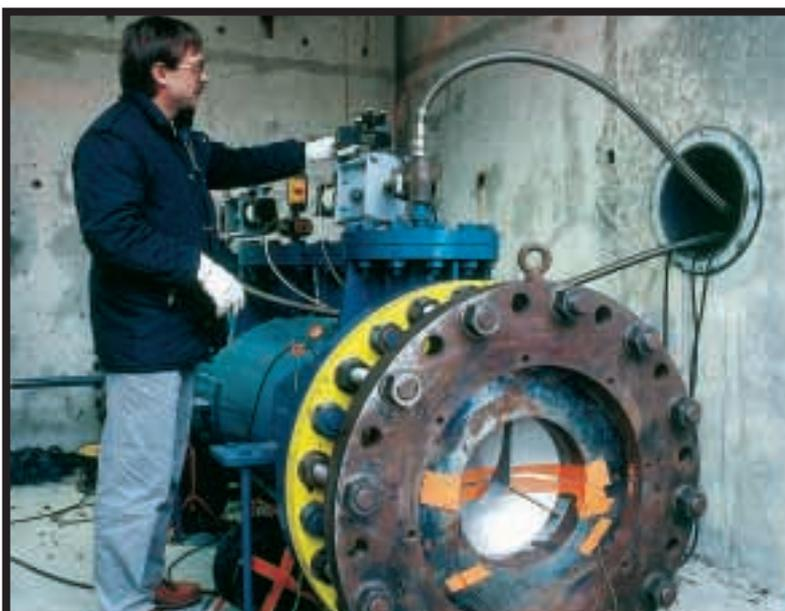
**Essai d'explosion d'un mélange air-méthane dans un récipient d'un mètre cube équipé d'un disque de rupture.**
