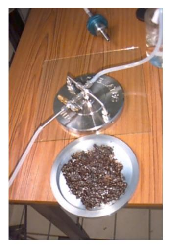
Figure 4 : Echantillon  $n^{\circ}$  3 réf. CHEN 00CS18 dans le support d'échantillon et la cellule FLEC (photo CSTB)
