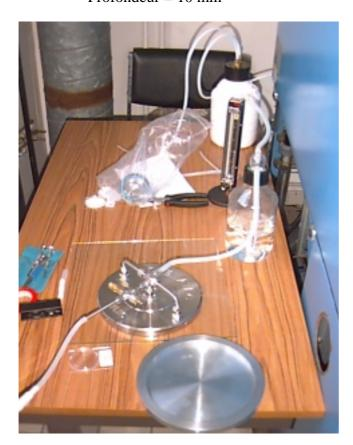
Figure 3: La cellule FLEC et le support d'échantillon (au premier plan)(photo CSTB)
