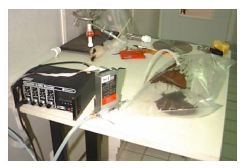
Figure 2 : Gonflage d'un sac Tedlar à l'air comprimé (photo CSTB)
