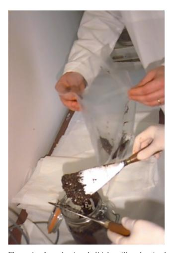
Figure 1 : Introduction de l'échantillon de pétrole dans un sac Tedlar (photo CSTB)
