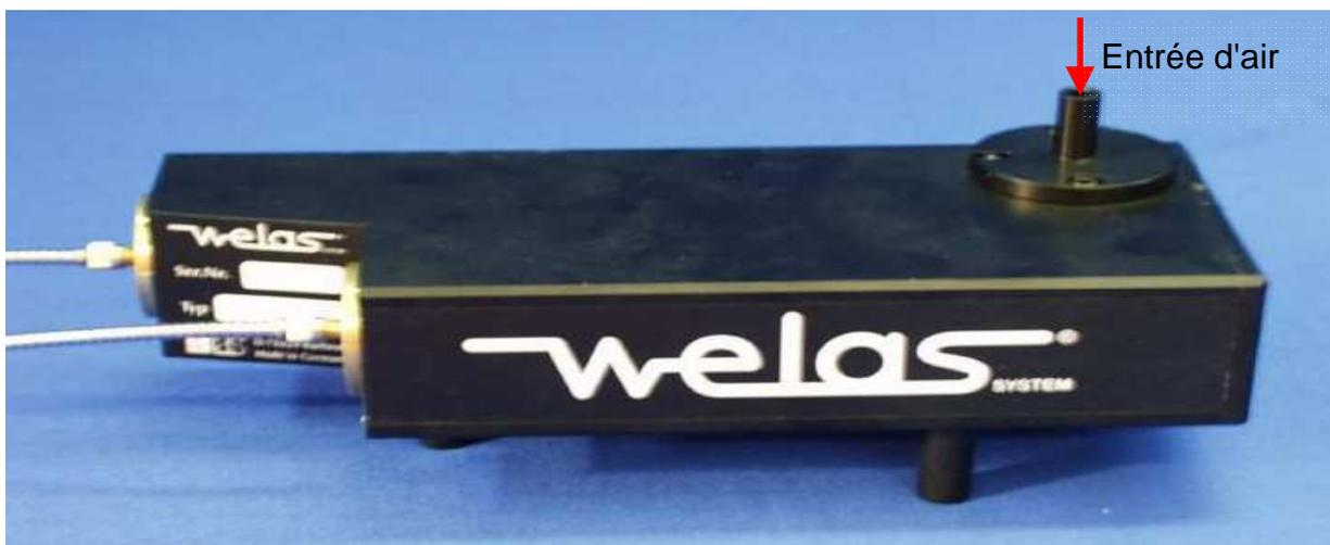
Tête de mesure (avec fibres optiques pour transmettre les données de mesures)
