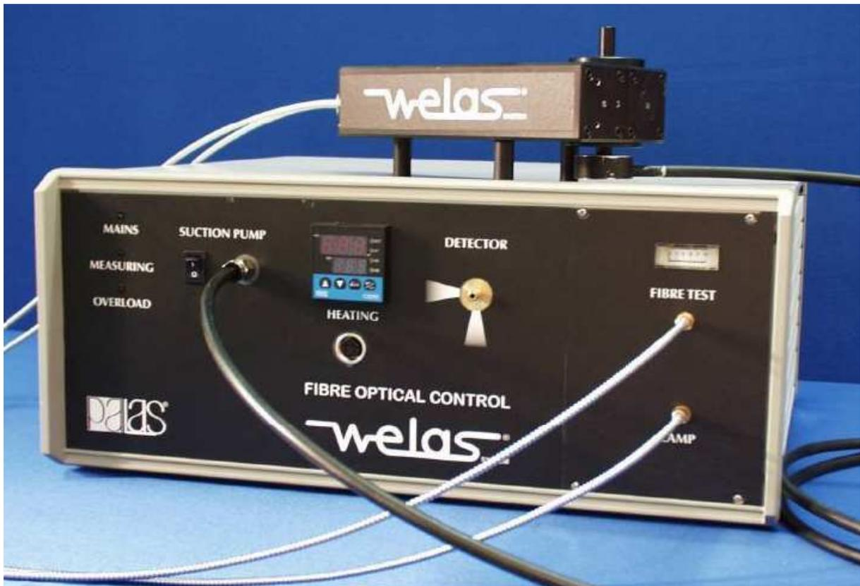
Boîtier d'analyse et tête de mesure (déportable)
