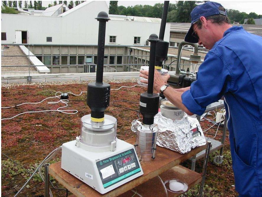
Figure 5 : Photographie du slit sampler (à gauche) et de l'impacteur Andersen à 6 étages (au centre).
