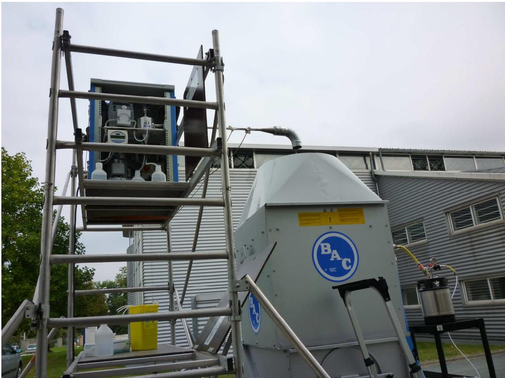
Figure 27 : Dispositif d'échantillonnage de la dispersion de BG à partir de la TAR.
