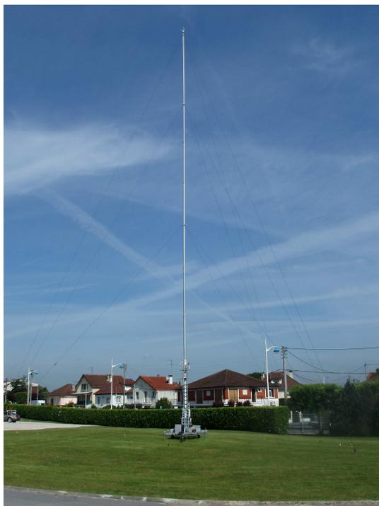
*Figure 10 : Mât météorologique télescopique de 30 mètres.*
