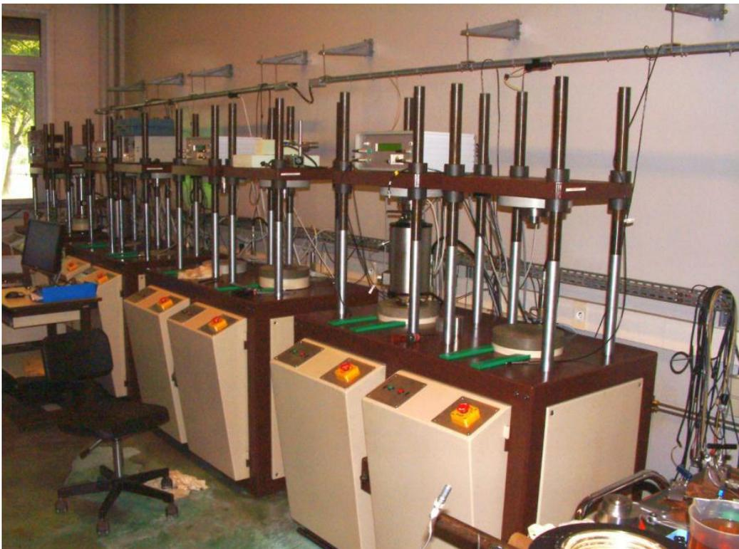
*Figure A6 : Banc d'essai pour l'étude du fluage du sel sous sollicitations cycliques (contribution du LMS-Ecole Polytechnique, d'après Berest, 2012)*
