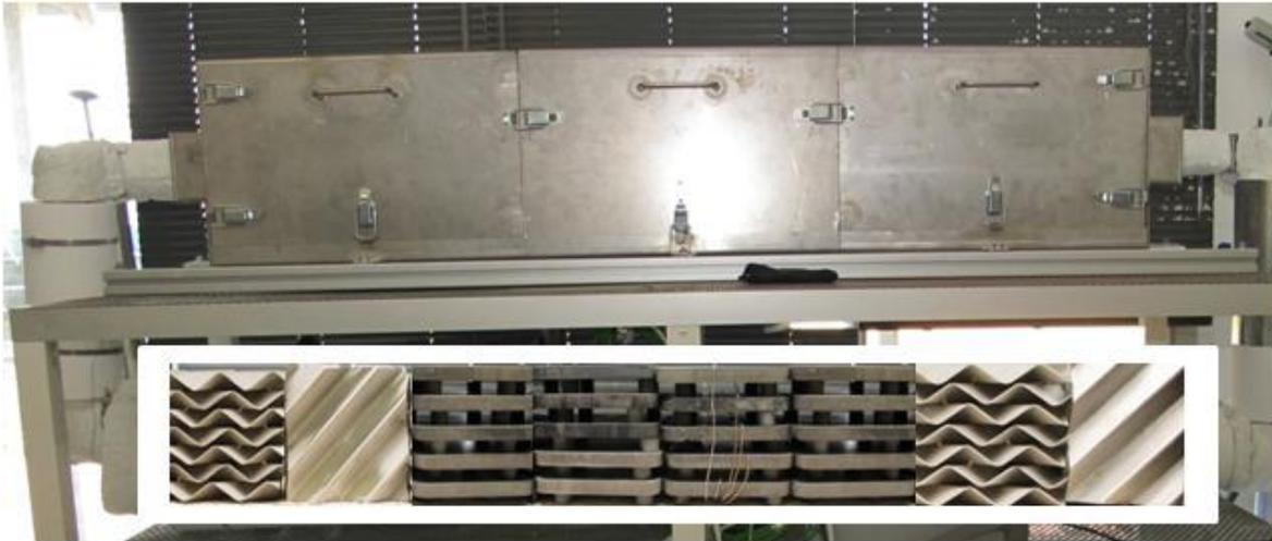
*Figure A5 : Banc d'essai de stockage/déstockage d'énergie sur matériaux recyclés (pour une gamme de température de 300 à 600°C) - Vue de la conduite d'air intérieure équipée de mélangeurs statiques et de plaques planes de stockage (contribution de PROMES, d'après Bérest, 2012)*
