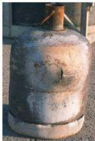
Figure 4 : Rupture ductile
