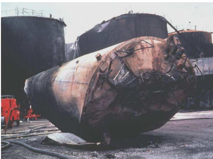
Figure 2 : Réservoir soufflé par l'explosion (fiche ARIA du BARPI, consultable sur <http://www.aria.developpement-durable.gouv.fr> , accident n°4998)
