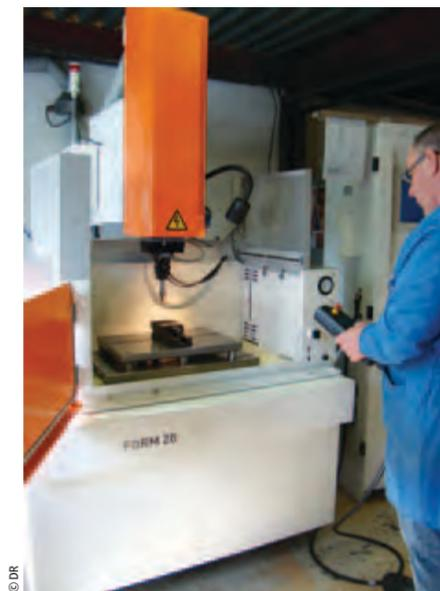
La machine d'électro-érosion par enfonçage acquise grâce à Croissance PMI.
