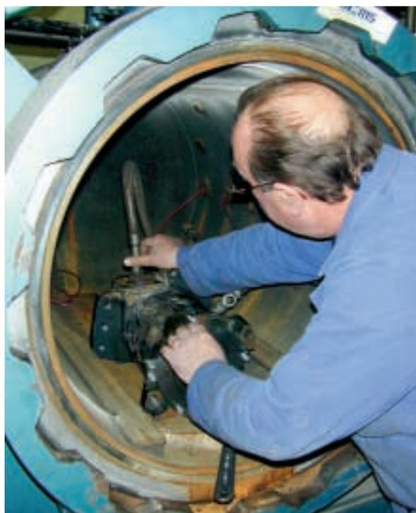
*Essai de matériel destiné à être utilisé en atmosphère explosible.*
