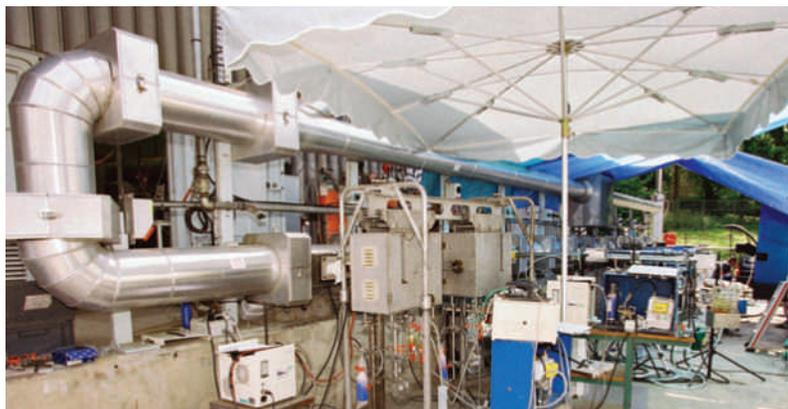
Dans le cadre de ses missions pour le LCSQA (Laboratoire Central de Surveillance de la Qualité de l'Air), l'INERIS a mis en place depuis 2007, un dispositif de caractérisation des particules dans l'air ambiant nommé «CARA». Basé sur une approche couplée entre l'analyse chimique des particules et la modélisation, il a pour but de mieux comprendre l'origine et les mécanismes de certains épisodes de pollution atmosphérique.
