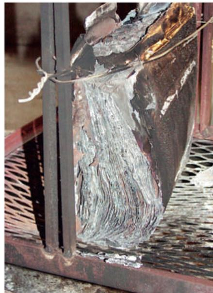
**Essai de combustion d'une batterie Li-ion**
