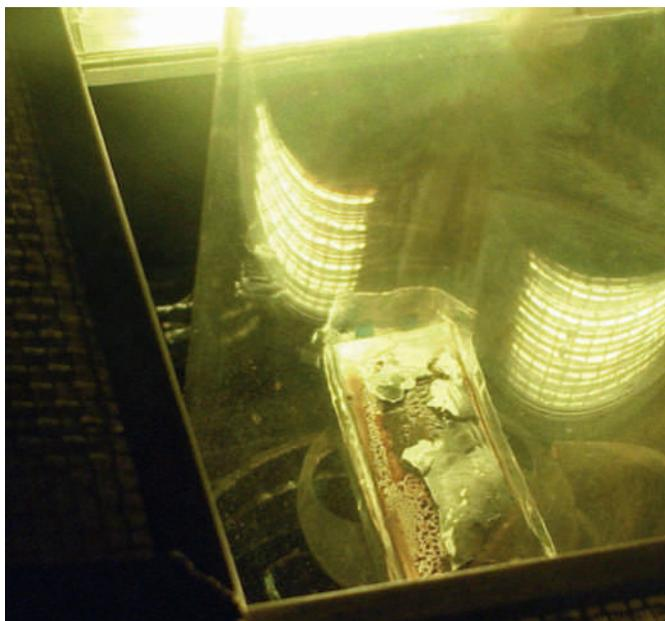
Essai au feu d'une batterie Li-ion au calorimètre de Tewarson
