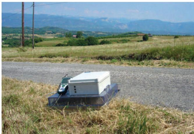
Chambre de mesure de flux de CO<sub>2</sub> en surface.
