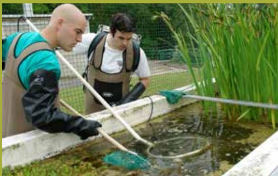
**Objectif :** reproduction d'écosystèmes artificiels à l'échelle 1 pour l'étude des effets à long terme des substances pharmaceutiques et chimiques sur les milieux aquatiques.
