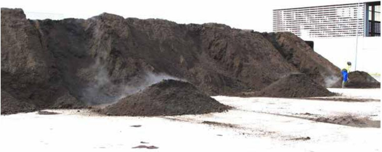
Figure 1 : exemple de prélèvement : ouverture de l'andain à la pelle mécanique
