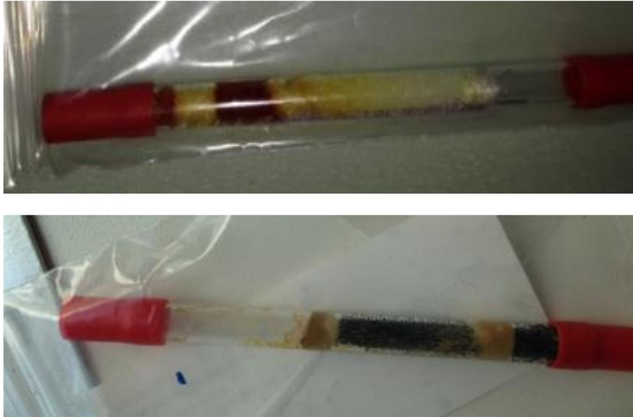
Figure 24 – Exemples de supports de prélèvement saturés en eau (gel de silice imprégné DNPH en haut et charbon actif en bas)
