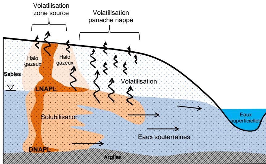
Figure 7 – Illustration des émissions gazeuses en zone source et des émissions gazeuses associées à un panache présent dans les eaux souterraines
