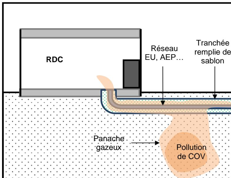
Figure 4 – Exemple de transferts de composés volatils vers l'air intérieur d'un bâtiment via les tranchées et les réseaux
