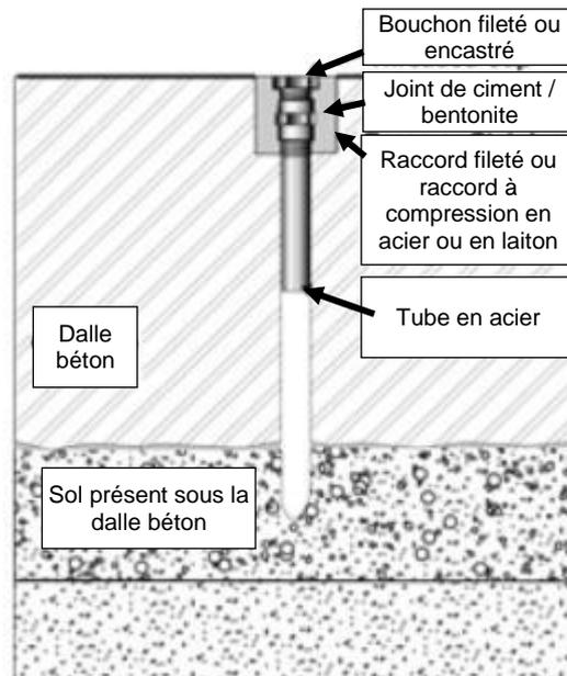
Figure 16 – Schéma de principe d'un Sub-Slab (source : US-EPA)
