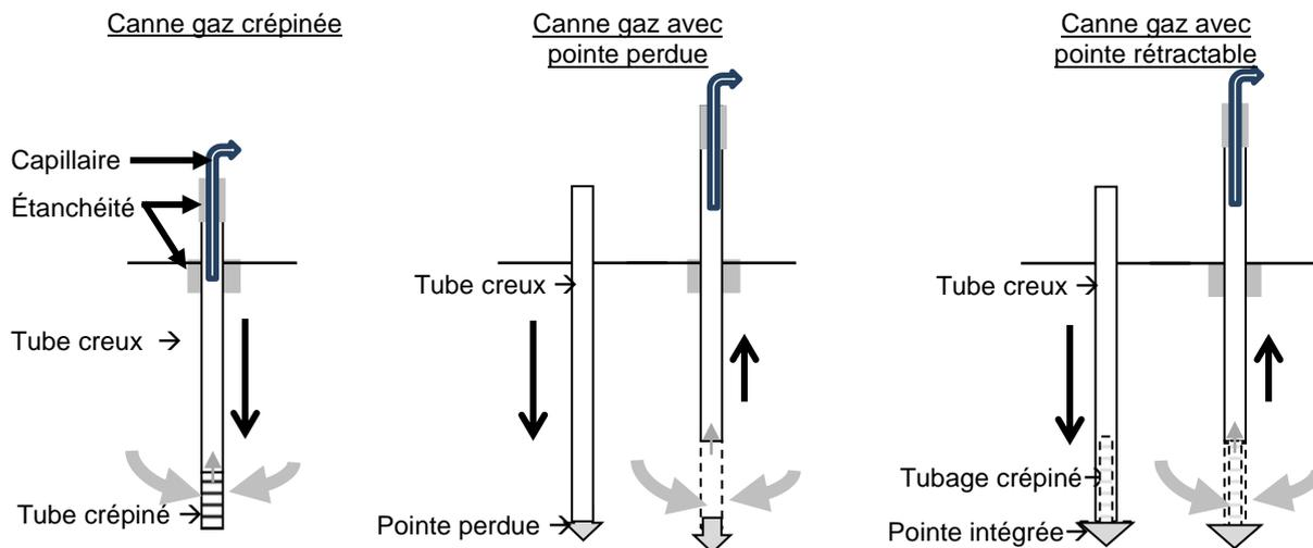
Figure 17 – Illustration des différents types de cannes gaz
