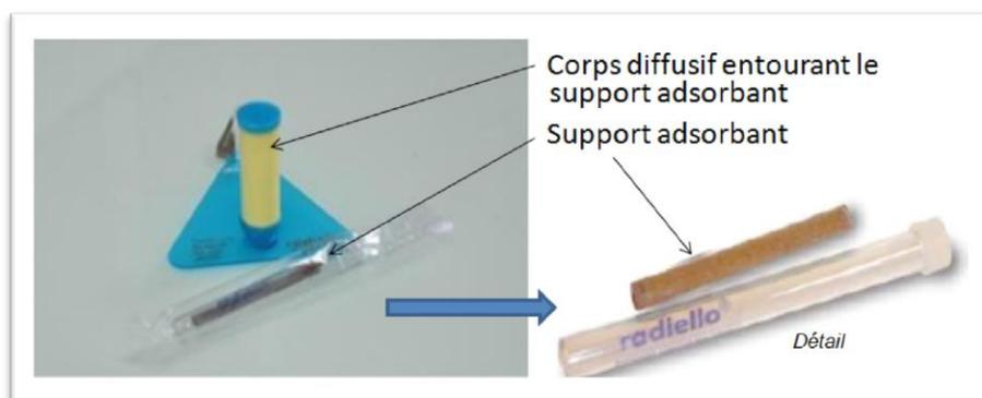
Figure 30 – Support "Radiello®" et son corps diffusif à diffusion radiale
