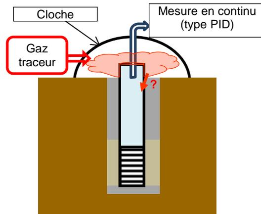
Figure 20 – Illustration d'un test d'étanchéité au gaz traceur
