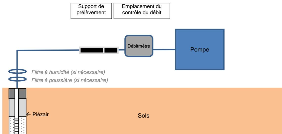
Figure 23 – Schéma de principe d'un prélèvement de gaz du sol (ligne simple avec 1 support de prélèvement)<sup>13</sup>
