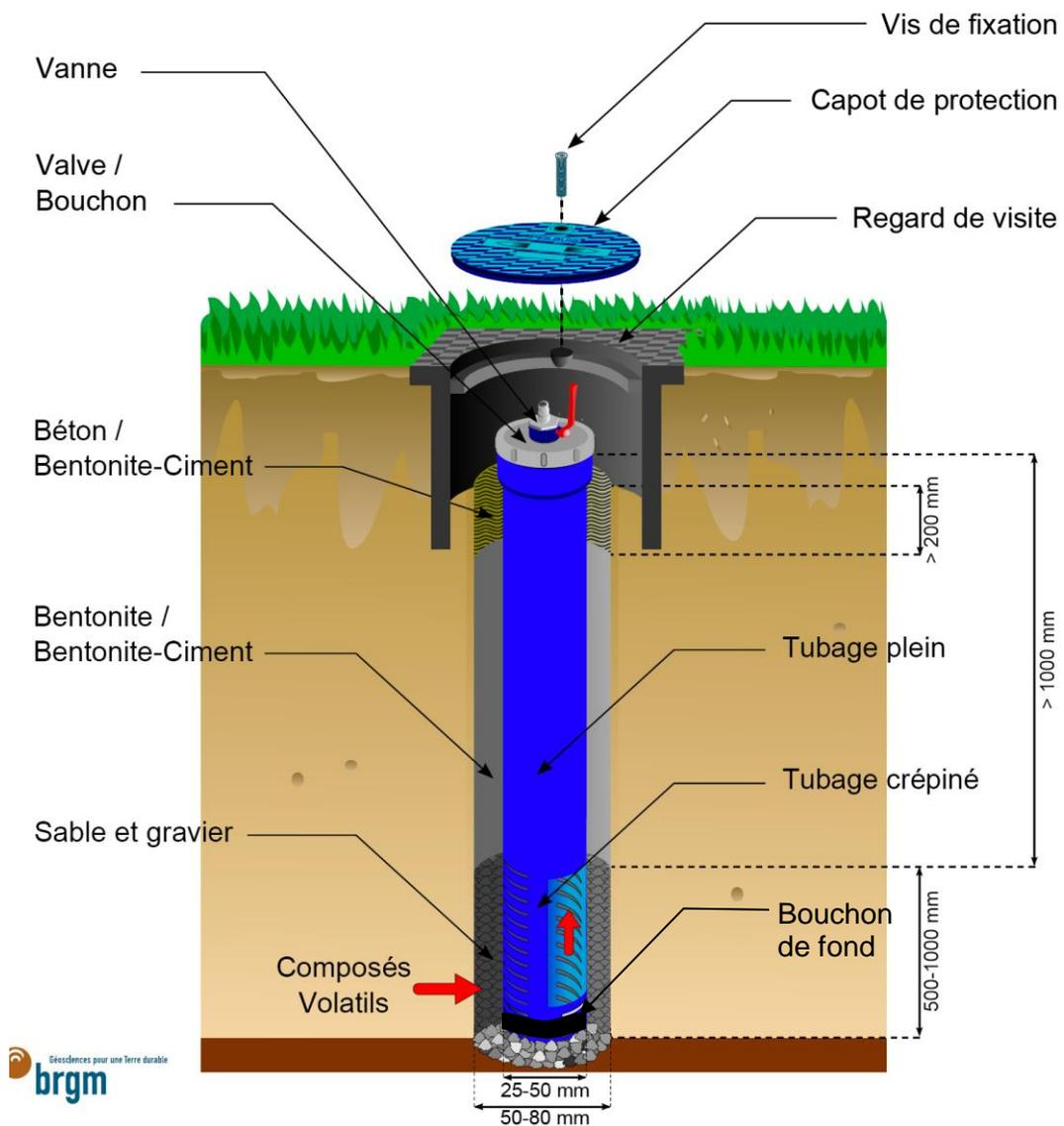
Figure 12 – Coupe schématique d'un piézair (unités en mm)
