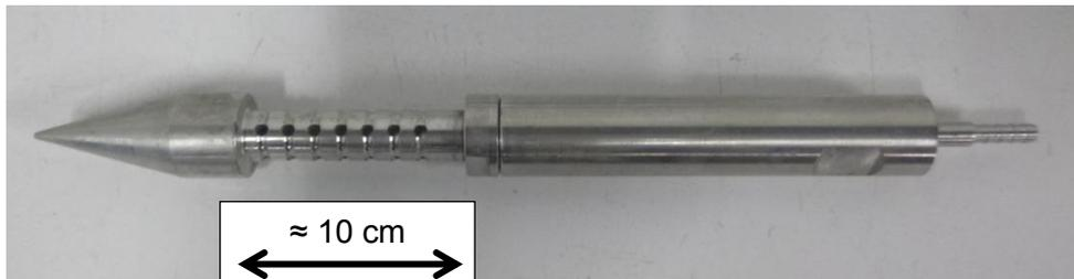
Figure 18 – Exemple de canne gaz à pointe rétractable
