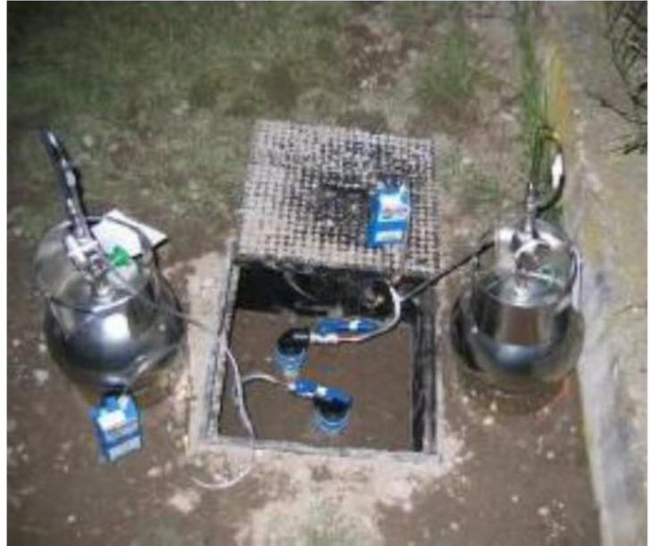
Figure 28 – Illustration d'un conteneur sous dépression (canister 6 L (source : projet Citychlor))
