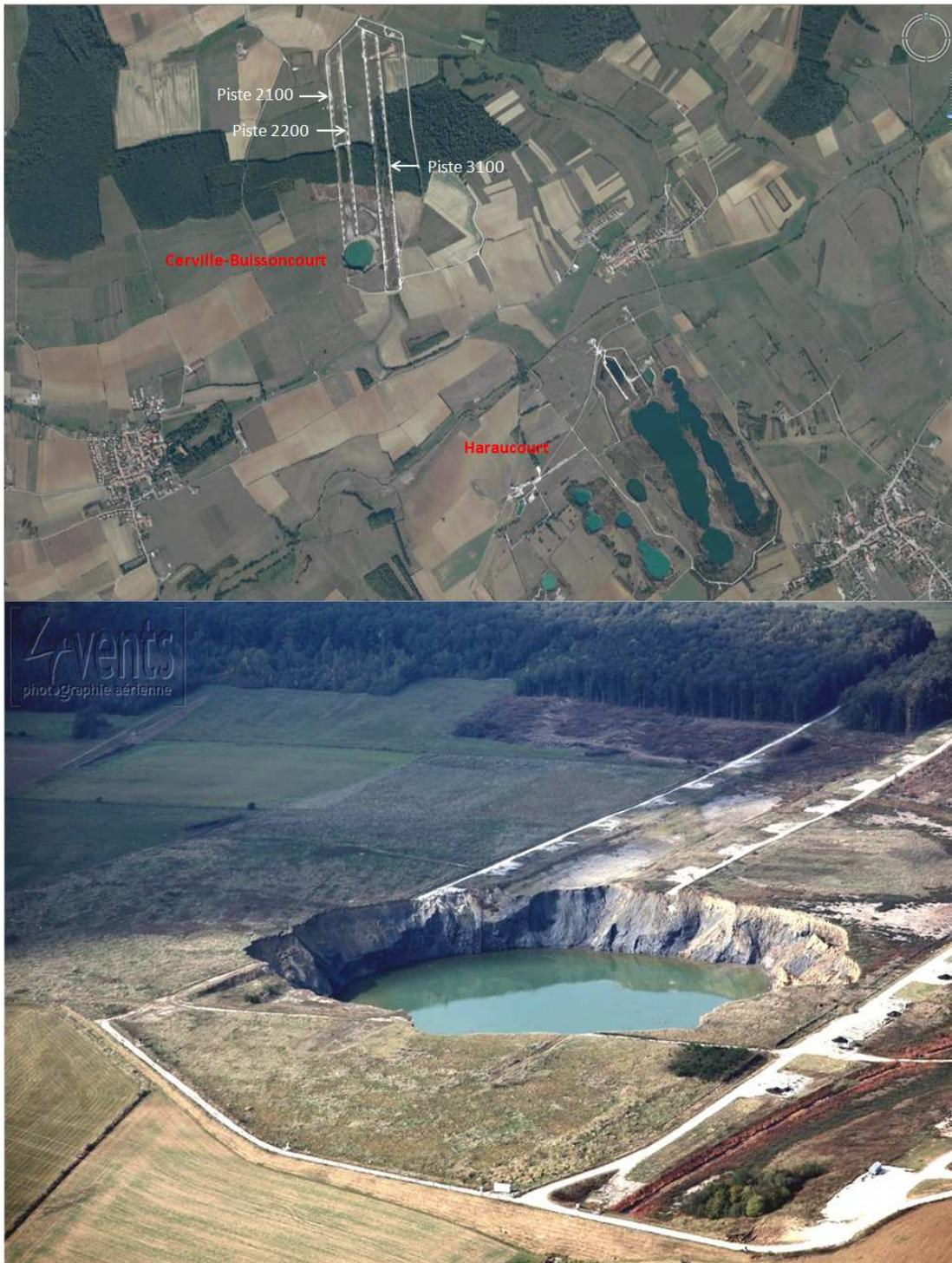
Figure 68 : Vues aériennes du cratère d'effondrement, au printemps 2009. (Sources : [www.geoportail.fr](http://www.geoportail.fr) et Solvay S.A.)
