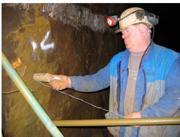
Figure 21 : Mise en place du bourrage lors de la préparation d'un forage de tir.
