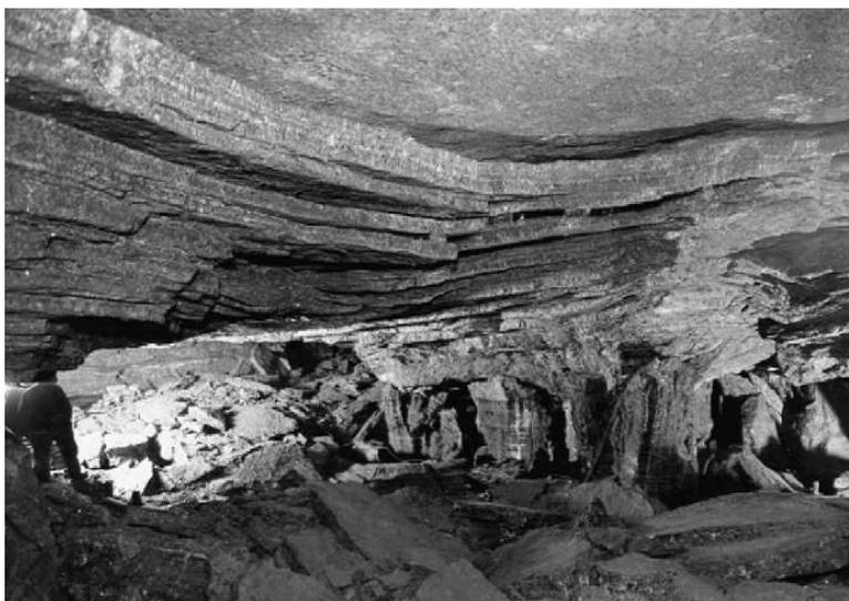
Figure 13 : Toit et pilier situés à proximité de la zone effondrée dans la mine de Varangéville. (Source : archives CSME, photo publiée dans Bérest et al., 2008)
