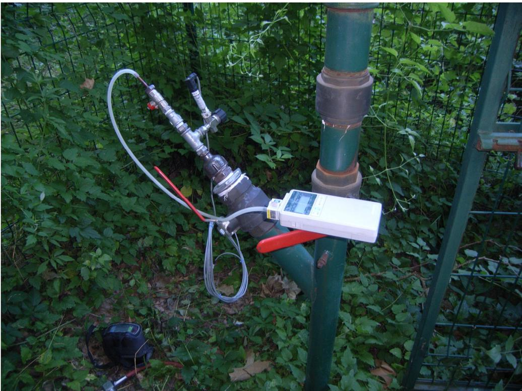
Photo A6-8. Mesure de la surpression dans les vieux travaux miniers via un sondage évent.
