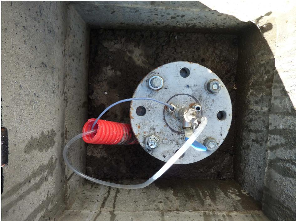
Photo A7-5. Tête d'un sondage fermé instrumenté pour les mesures en continu de pression différentielle et de température dans les vides post miniers.
