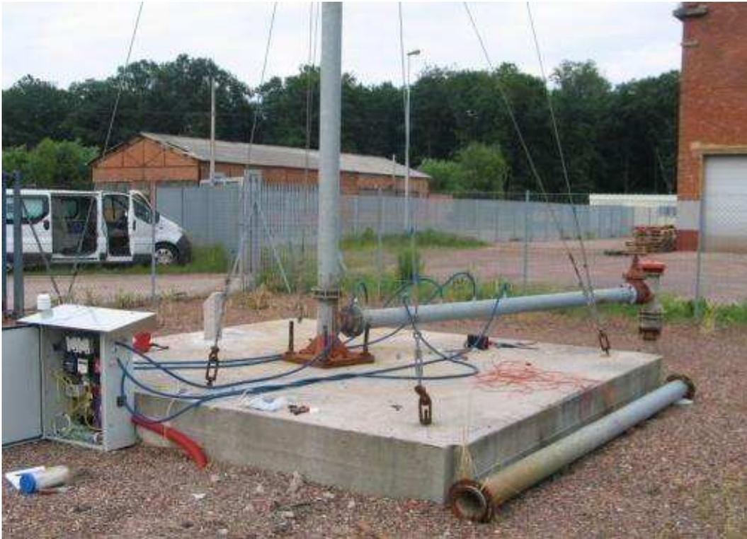
Photo A7-7. Instrumentation pour les mesures gazeuses en continu sur un événement de décompression installé en tête d'un puits dans une mine de charbon fermée.
