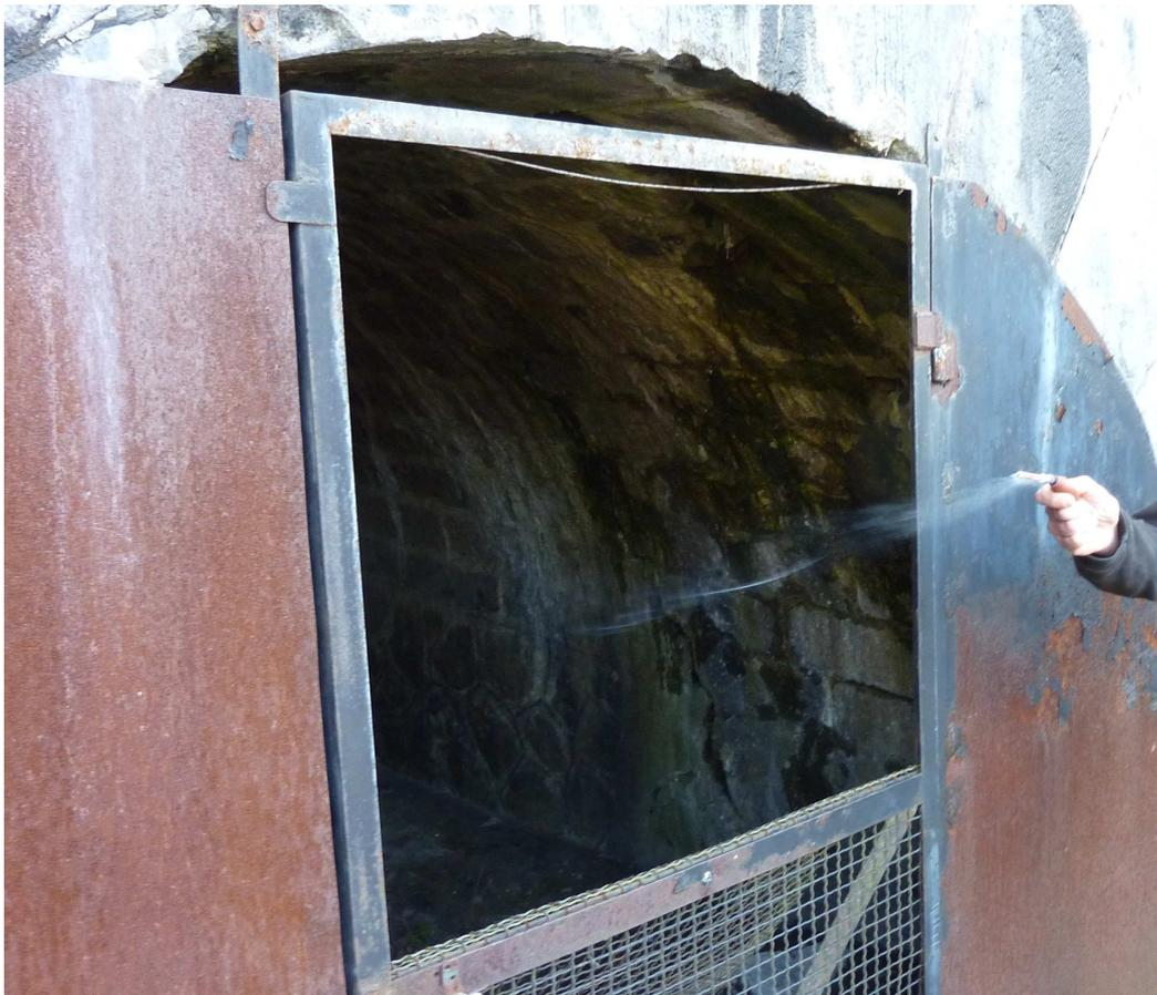
Photos A6-1 et A6-2. Détermination au fumigène du sens d'écoulement à l'orifice d'une galerie non obturée.
