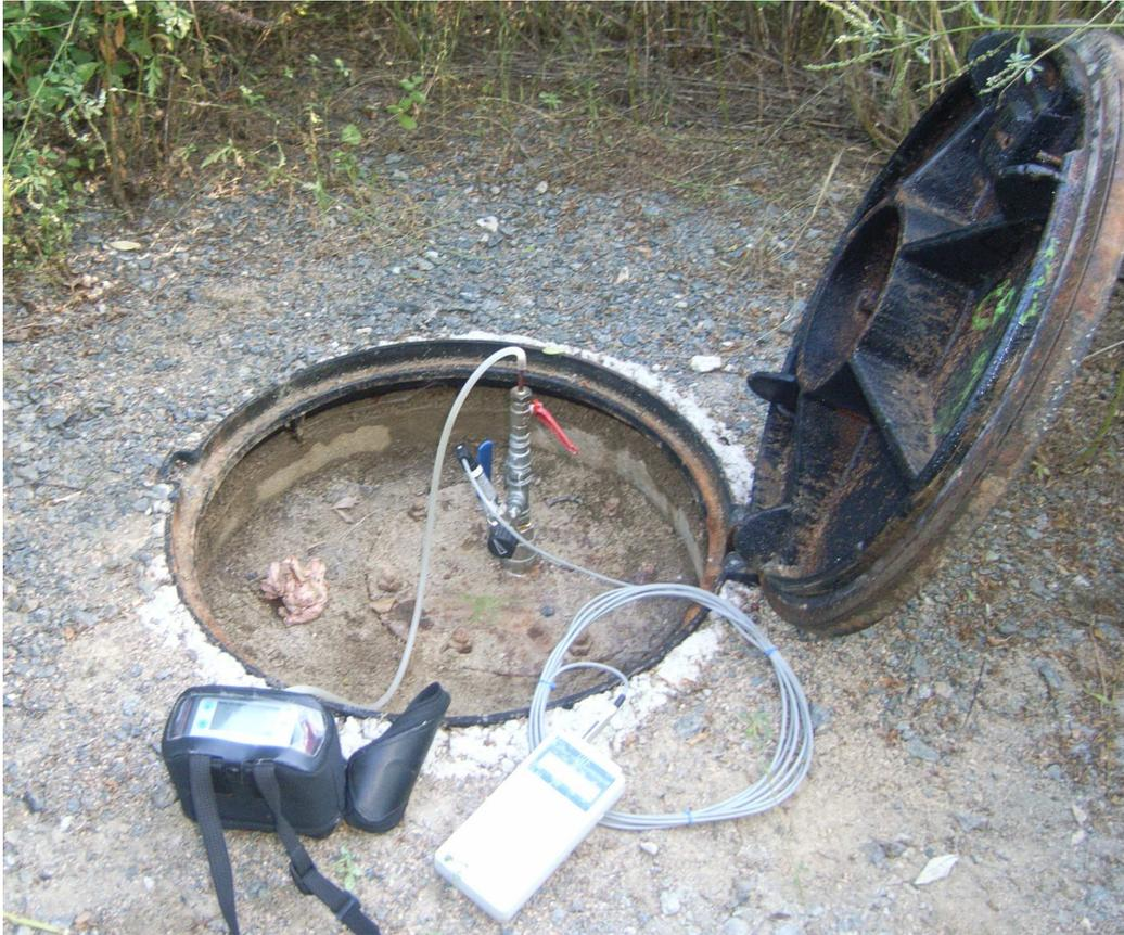
Photo A6-7. Mesure de la surpression et de la composition de gaz en tête d'un sondage de contrôle fermé débouchant vers des vieux travaux miniers.
