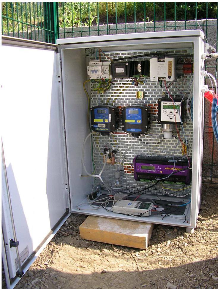
Photo A7-6. Exemple de station de mesure en continu des paramètres gazeux.
