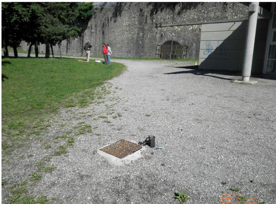
Photo A6-12. Contrôle de la présence de gaz de mine dans un réseau enterré situé dans le secteur d'une ancienne exploitation souterraine de charbon
