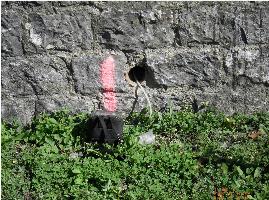
Photo A6-3. Contrôle de l'atmosphère derrière un mur de soutènement à proximité d'une galerie de mine fermée.
