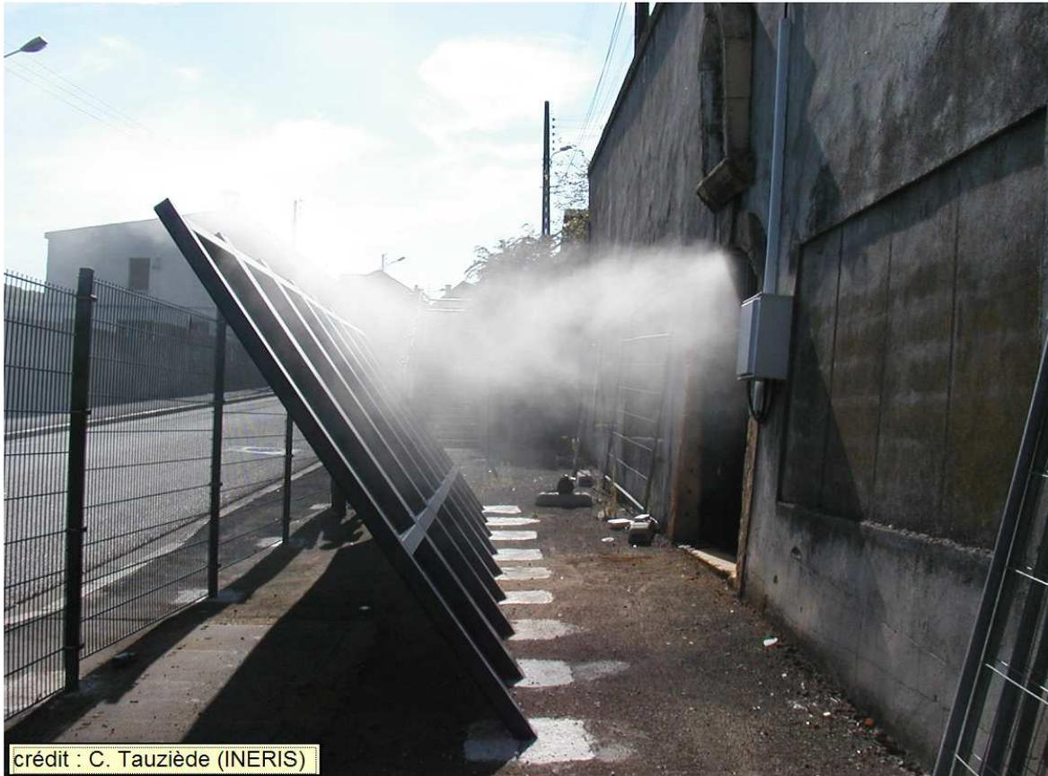
*Figure 6. Visualisation, à l'aide de fumigène, de la sortie de gaz de mine par une galerie minière ouverte, dans le bassin ferrifère lorrain.*
