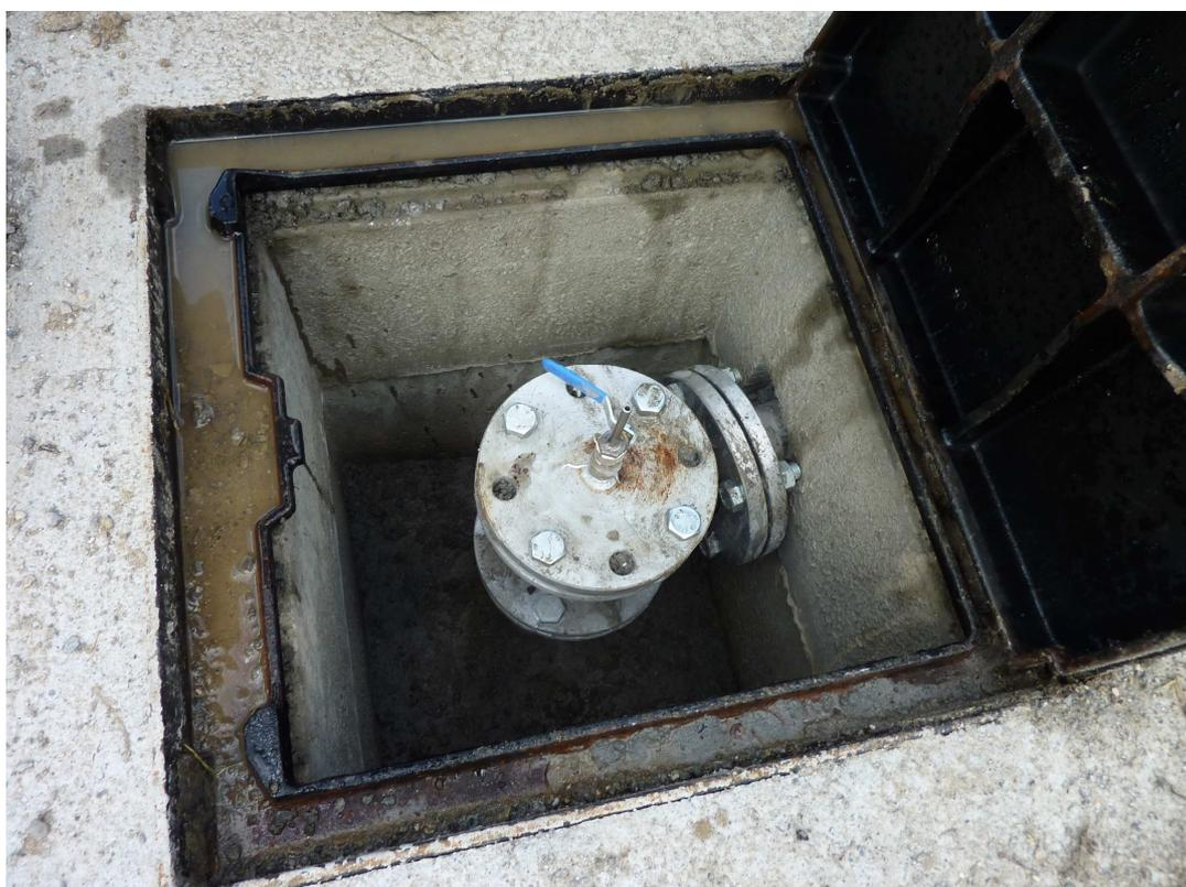
Photo A7-2. Tête de sondage avec une dérivation vers un évent, équipé d'un piquage pour les mesures gazeuses.
