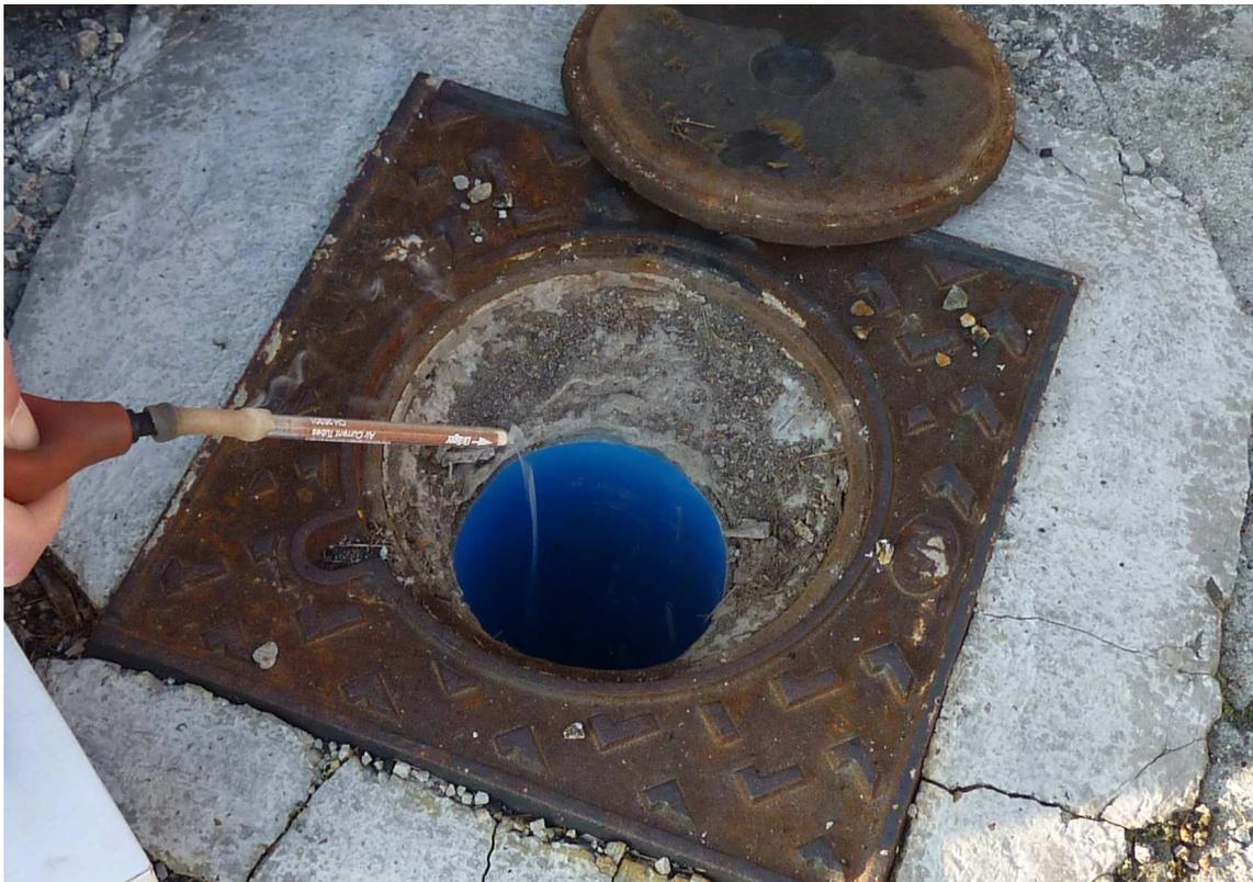
Photo A6-4. Détermination au fumigène du sens d'écoulement à l'orifice d'un forage débouchant vers des vieux travaux miniers.
