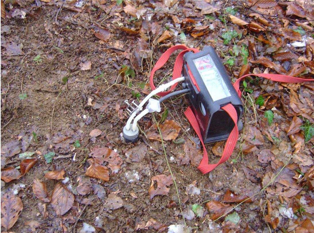
Photo A6-9. Mesure de la composition des gaz dans le sol via un petit forage tubé.
