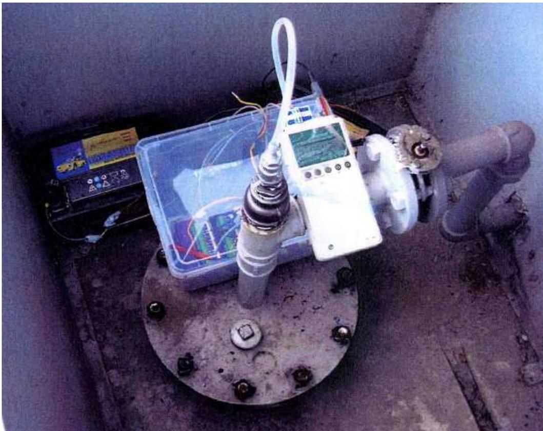
Photo A7-8. Instrumentation simplifiée pour les mesures en continu de la pression différentielle en tête d'un puits.
