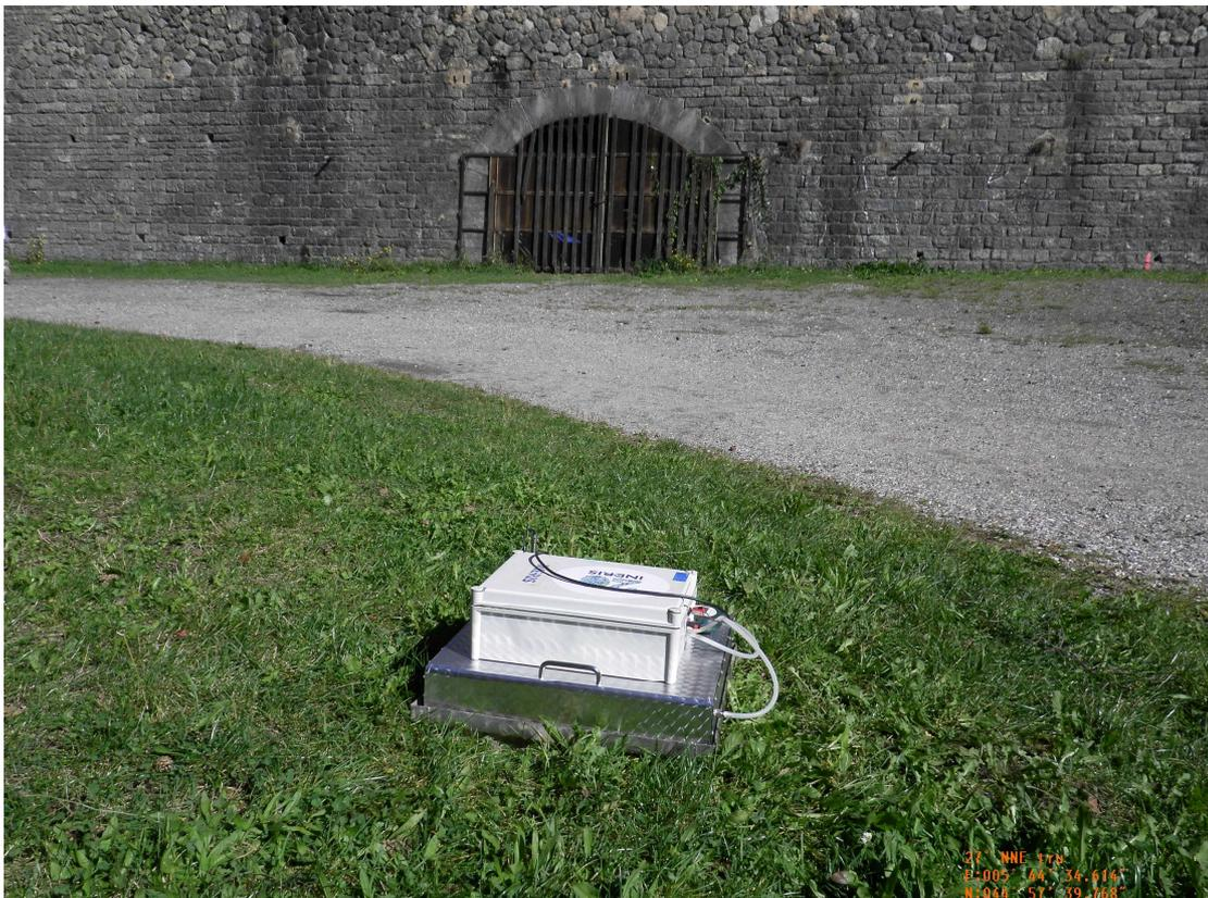
Photo A6-10. Mesure du flux gazeux du sol avec une chambre à accumulation.
