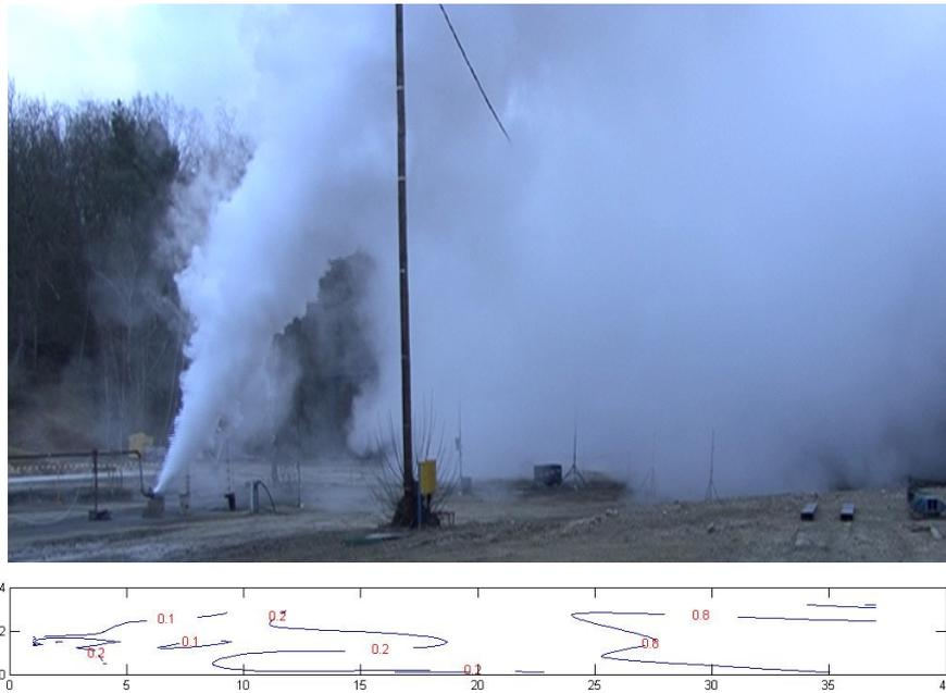
Figure 40 : Nuage visible pour une simulation de rejet en cratère (enveloppe visible du nuage estimée ici à 0.5%vol. de CO<sub>2</sub>)
