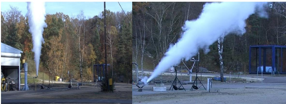
Figure 37 : Nuage visible dans une configuration d'essai de rejet vertical et à 45°
