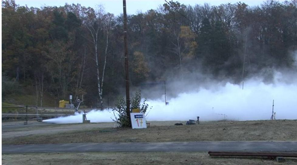
*Figure 38 : Nuage visible dans une configuration d'essai de rejet rasant*
