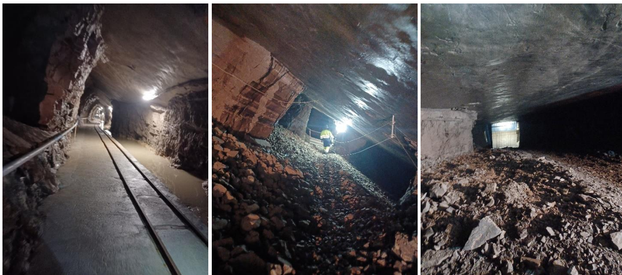
Figure 1. Gauche : voie ferrée (entrée et sortie principale de la mine) ; centre : chemin piéton dans l'exploitation ; droite : chute du minerai par gravité
