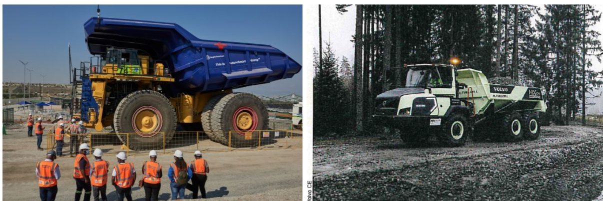
Figure 9. A gauche : camion prototype, motorisation hybride pile à combustible-batteries [source : Anglo American] ; à droite : tombereau prototype articulé à pile à combustible hydrogène [source : Volvo CE]
