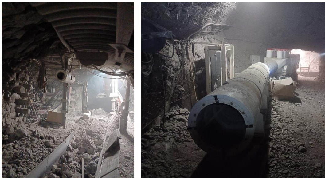
Figure 8. (Gauche) bande transporteuse ; (droite) dépoussiéreur
