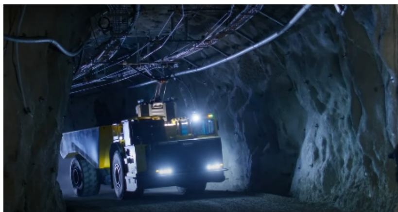
Figure 8. Exemple de camion minier à batteries, assisté d'un système de type 'trolley' sur un chemin d'accès principal (mine d'extraction de métaux en Suède) [source : Epiroc]
