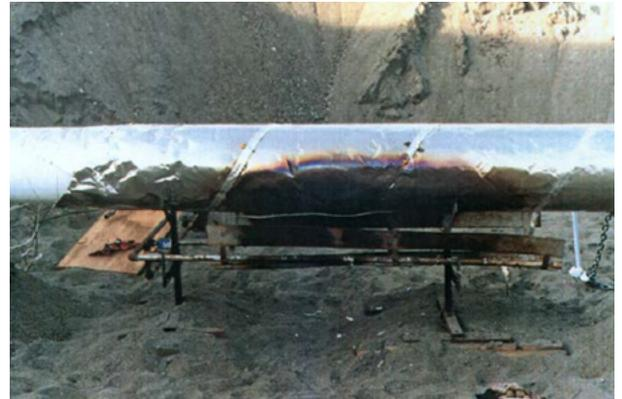
b- Etat de surface d'un réservoir composite enveloppé d'une couverture céramique
