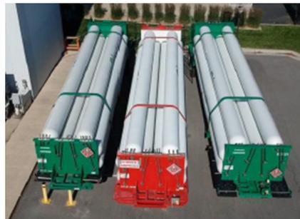
Des réservoirs allongés (appelés « cigares ») de 1100 à 1900 litres sous des pressions de 200 à 380 bar
