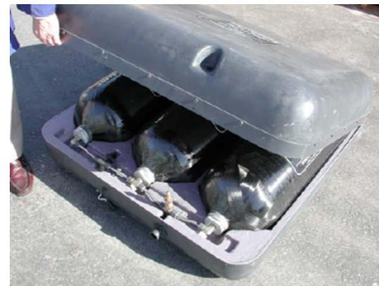
Encapsulation des réservoirs dans une enceinte résistante
