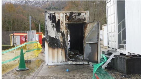
*Figure 5 : Photo du conteneur de stockage d'énergie le lendemain de l'incendie*
