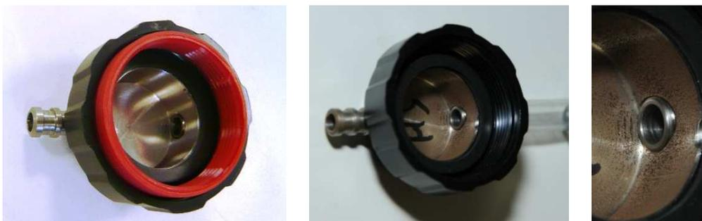
*Figure 8 : Coiffe de l'appareil D3 avant et après les essais (corrosion due au HCl)*
