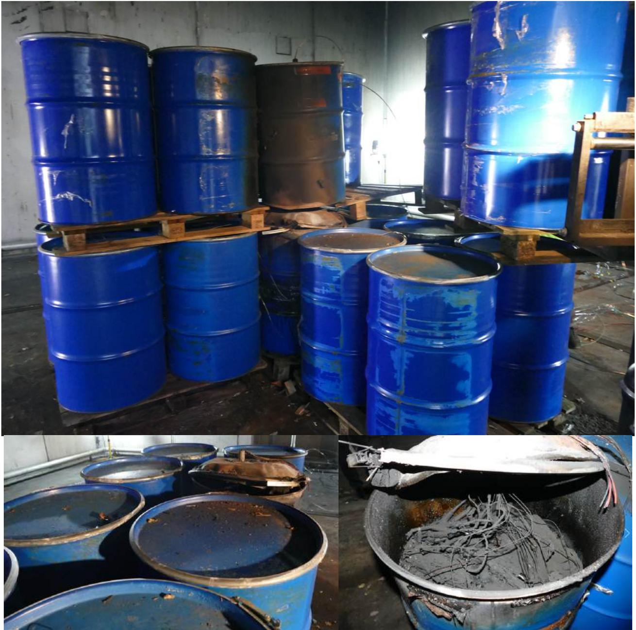
*Figure 63 : photos des fûts après essais (dessus : vue globale après avoir dégagé la vue vers le fût rempli de batteries, gauche : couvercle bombé du fût initialement rempli de batteries, droite : intérieur du fût rempli de batteries)*
