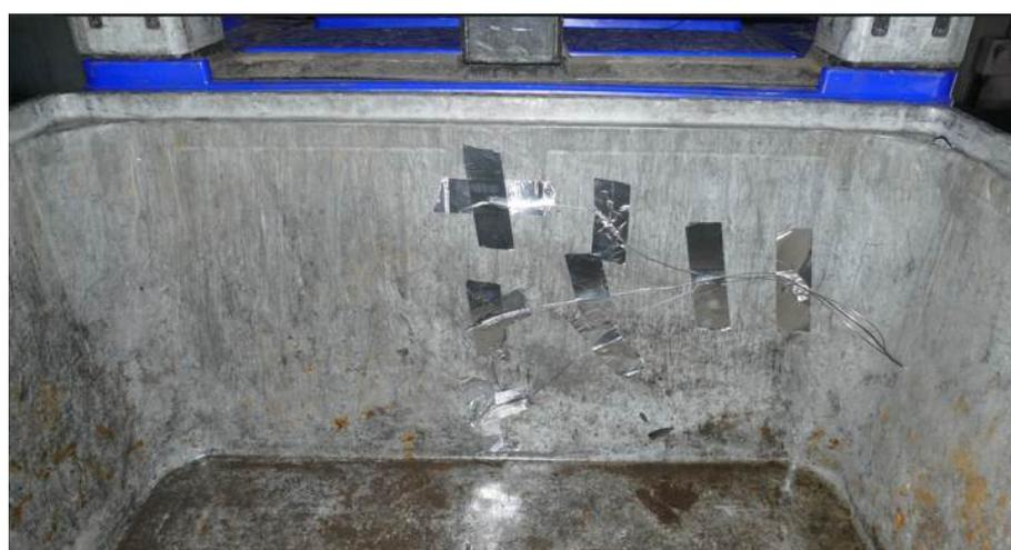
Figure 11: position des 3 thermocouples « palox-cote-x » au sein du palox 3
