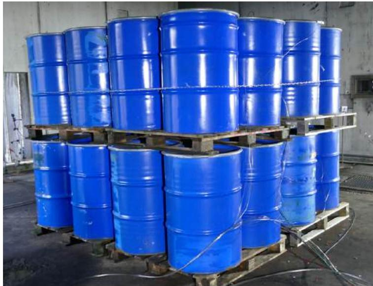
Figure 45: configuration de l'essai 3 : 8 palettes de quatre fûts, réparties sur deux étages
