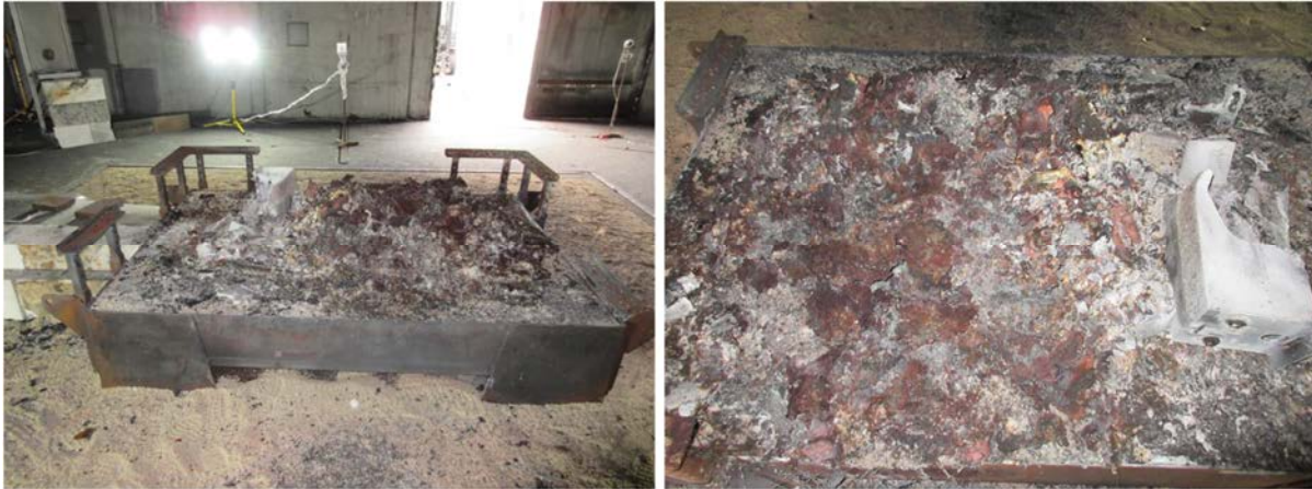
Figure 75 : Photos après l'essai de propagation caisse
