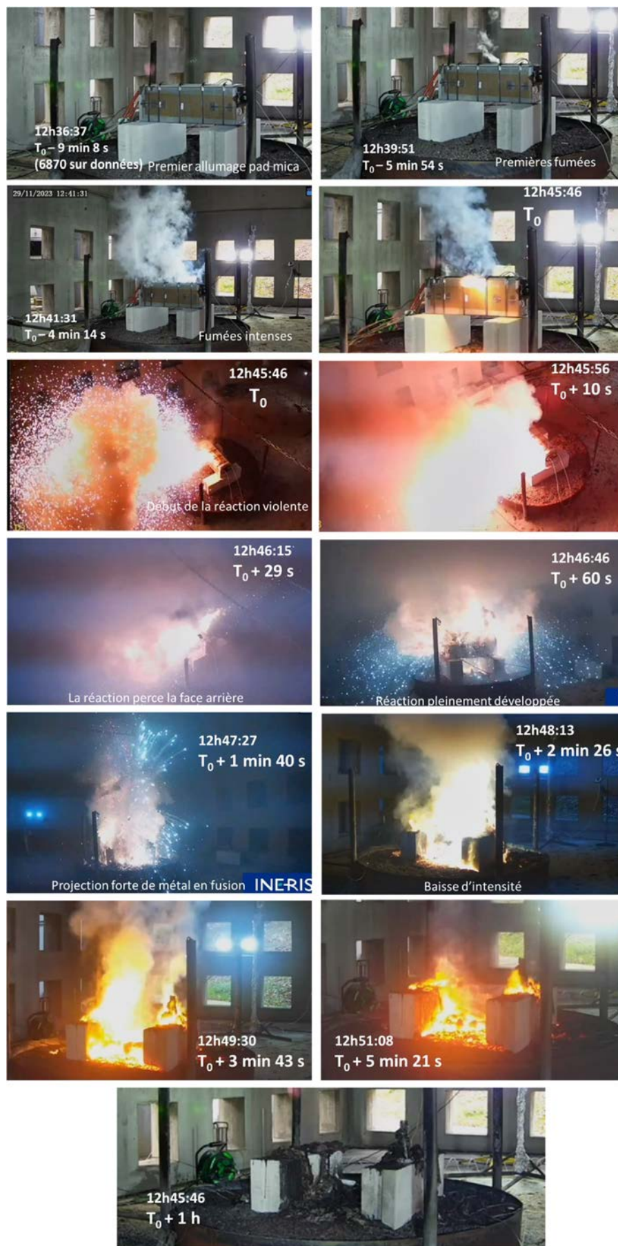
Figure 31 : Extraits de la vidéo de l'essai de surchauffe par pad module
