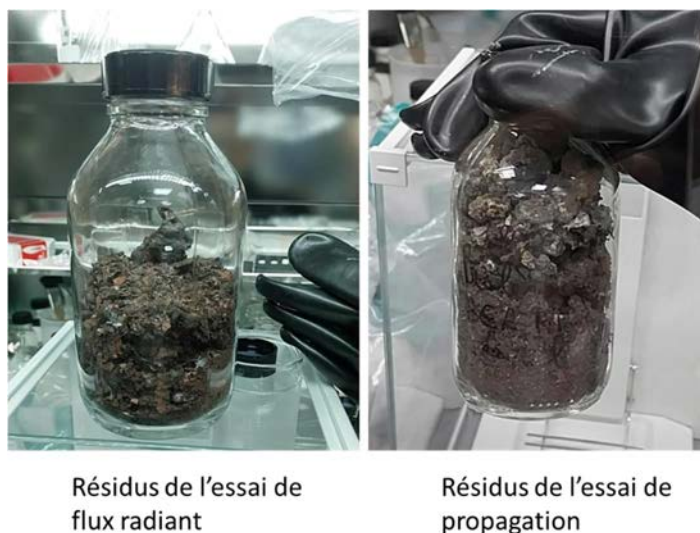
Figure 154 : Photographies des résidus prélevés pour analyse
