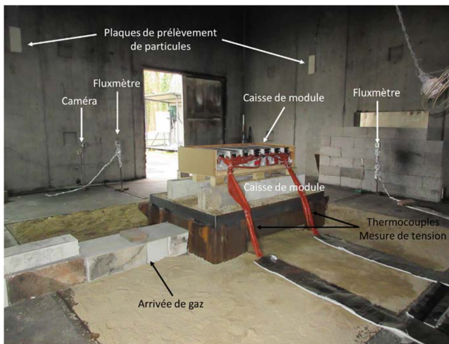
Figure 57 : Montage expérimental de l'essai feu caisse
