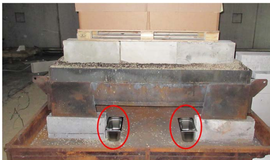
Figure 102 : Réceptacles de collecte des eaux d'extinction
