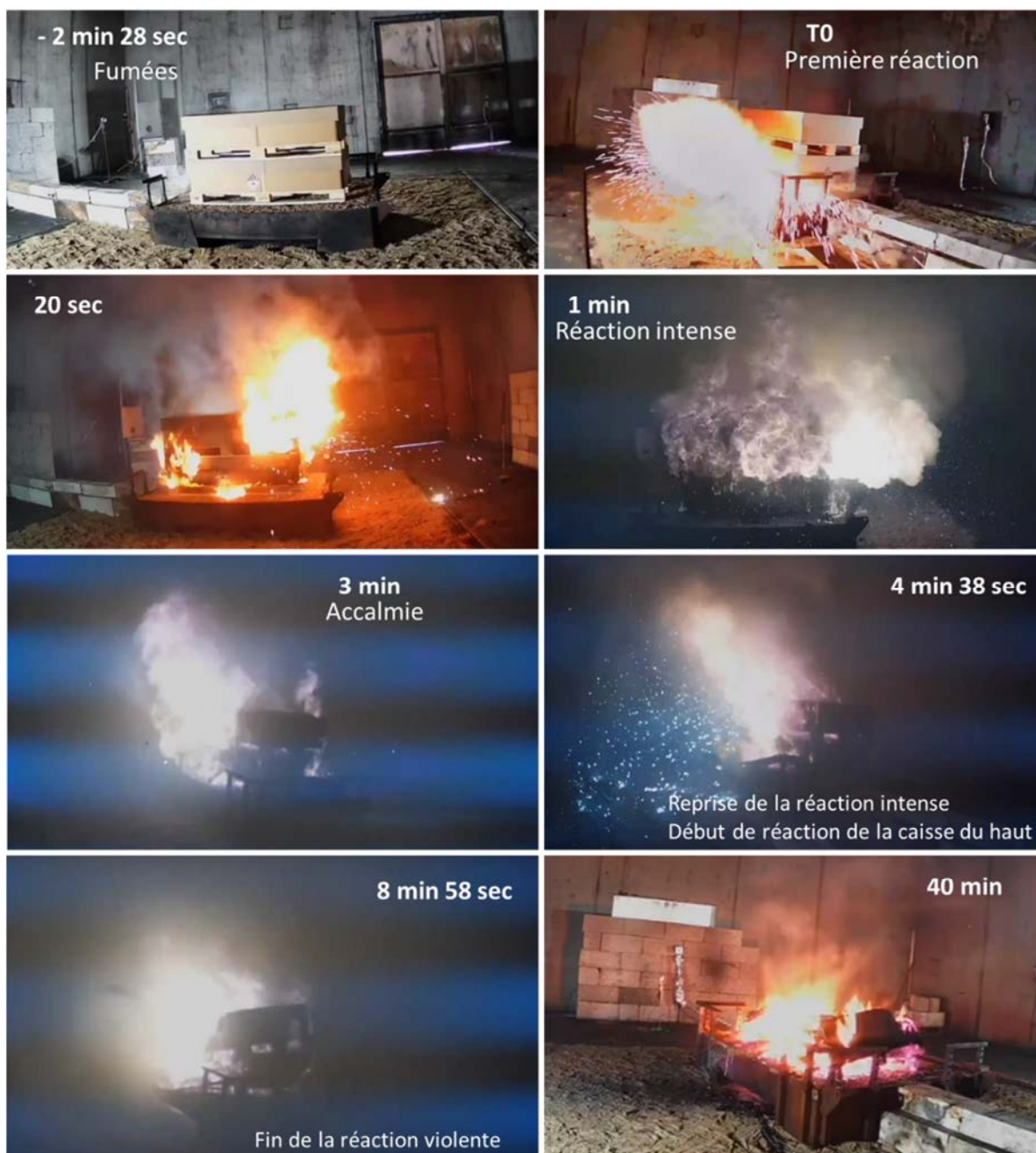
Figure 74 : Captures d'écran des caméras lors de l'essai de propagation caisse
