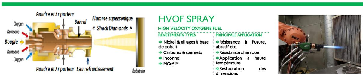
Figure 9 : Schéma de principe de la torche HVOF (source partenaires 2 et 4)
