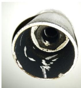
Figure 101 : Dépôt de suies en sortie de filtre de la M270
