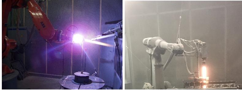
Figure 22 : Torche plasma (APS) et flamme à haute vitesse (HVOF)
