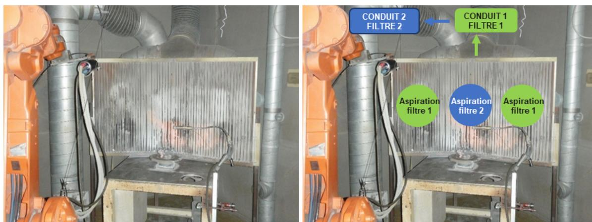
Figure 104 : Cabine de projection thermique avec le panneau aspirant fixe
