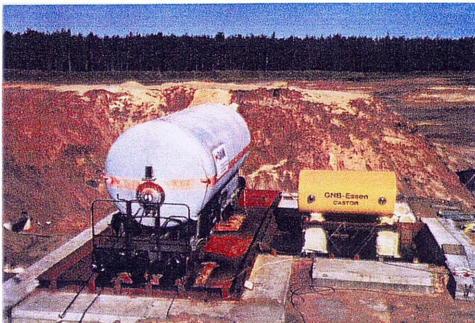
Figure D.16 : Vue de l'installation d'essai : le wagon de propane est à gauche ; à droite, un petit réservoir de transport de matières radioactives est placé perpendiculairement au wagon.
