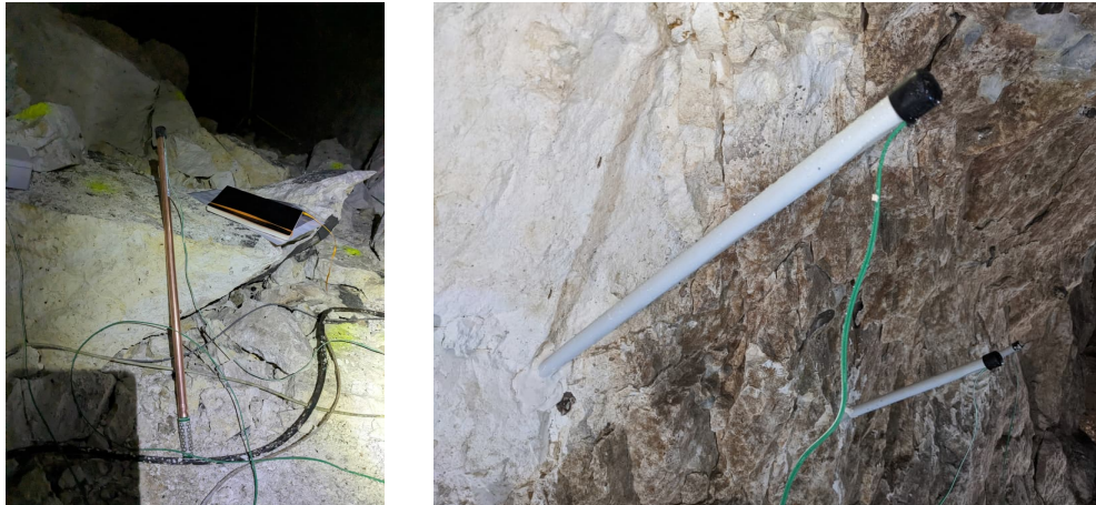
Figure 18 : Capteur de succion type WATERMARK Model 200SS (à gauche). Capteurs de succion dans le pilier (à droite)
