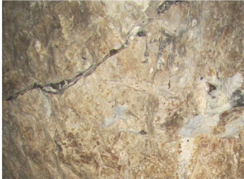
Figure 51 : Diaclase à veine siliceuse de direction N80 (pendage de 72° orienté Nord). Prise de vue depuis le coin Nord-Ouest du pilier (Gaumet et al., 2021).
