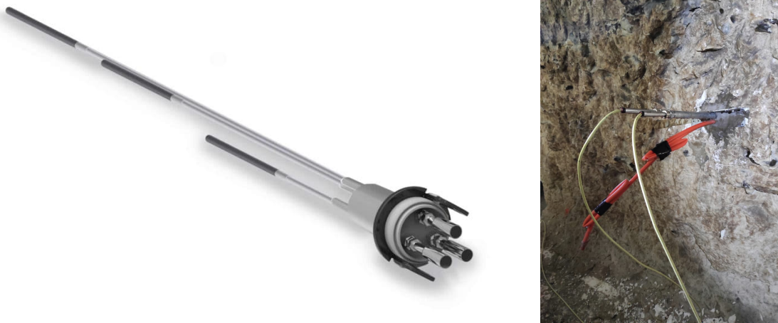
Figure 20 : Extensomètre 2 points en forage (Source : Sisgeo) (à gauche). Extensomètre dans le pilier (à droite)
