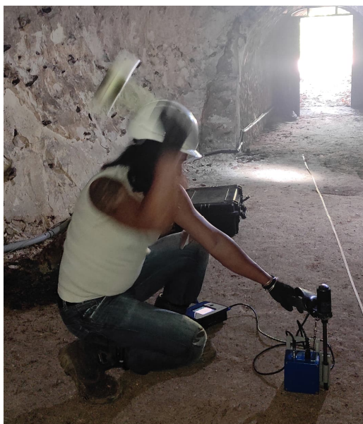
Figure 12 : Essais pénétrométriques réalisés par le Cerema en mai 2021
