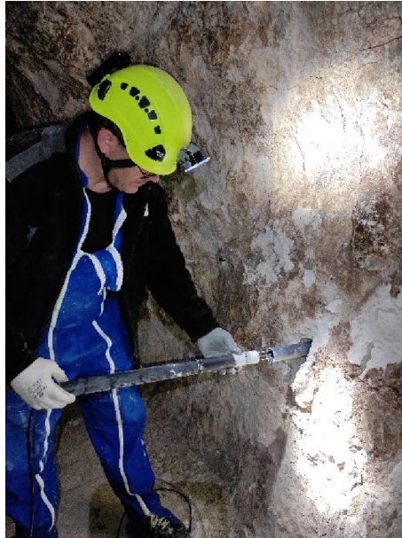
Figure 16 : Installation des capteurs de teneur en eau
