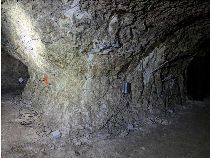
Figure 14 : Pilier instrumenté dans la zone des petites piliers – Zone A
