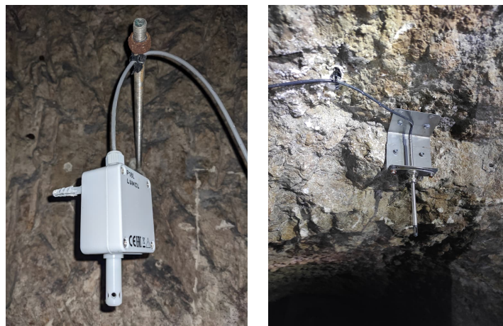
Figure 24 : Station climatique dans la carrière (à gauche). Capteur de température à l'extérieur au-dessus de l'entrée 1 (à droite).
