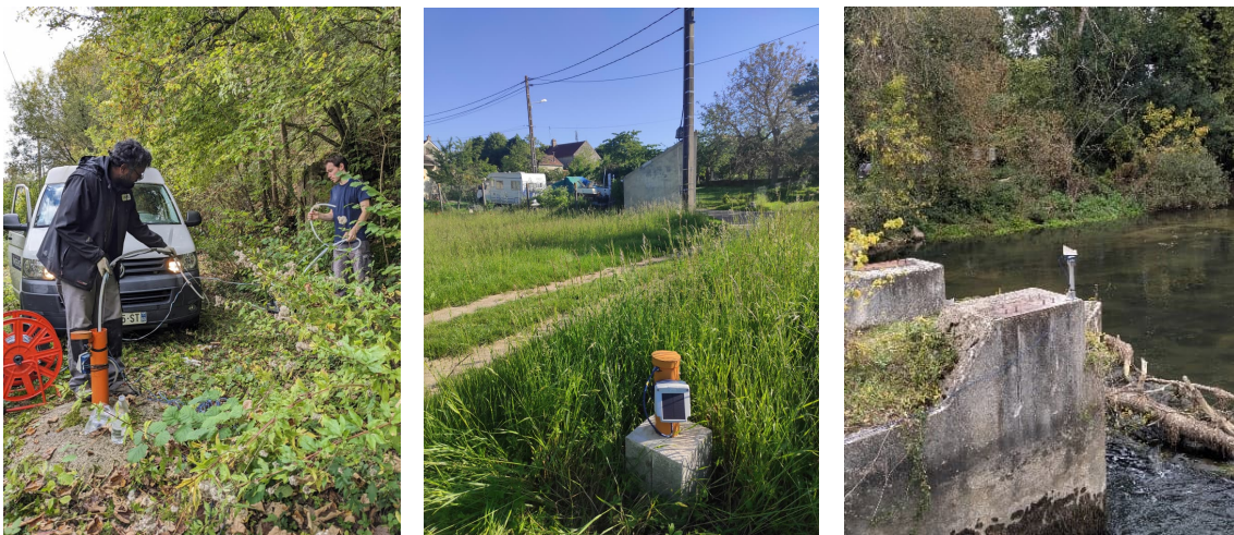
Figure 19 : Nettoyage de la sonde piézométrique SD2 (à gauche). Forage piézométrique SD1 (au milieu). Limnimètre dans le Loing (à droite)
