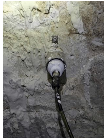
Figure 17 : Capteur Thetaprobe (à gauche, source : agriexpo). Capteurs de teneur en eau dans le pilier (à droite)
