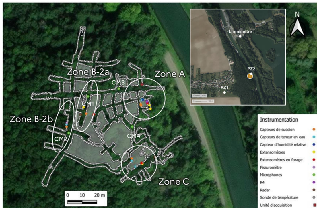
Figure 15 : Implantation des zones d'étude et du réseau de capteurs de l'observatoire de Château Landon – CIMx : microphones
