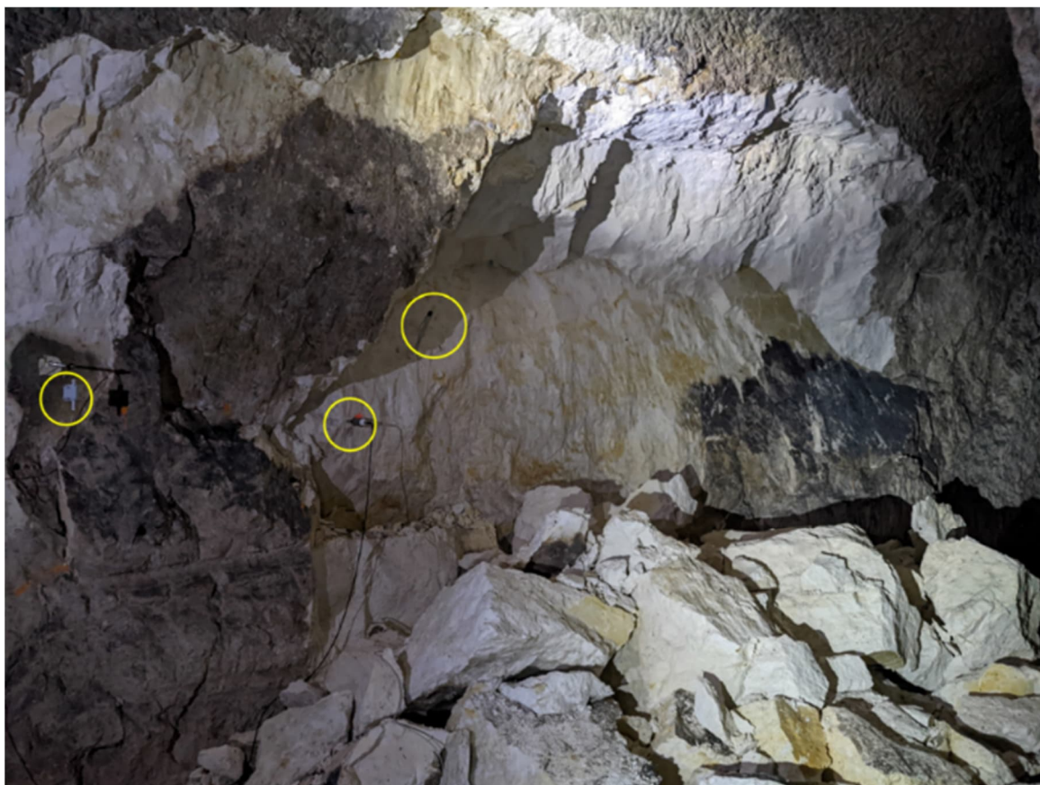
Figure 65 : Exemple de capteurs de température, de teneur en eau et de succion (de gauche à droite) en Zone B – 2a
