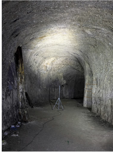
Figure 22 : Capteur acoustique sur pied dans la carrière
