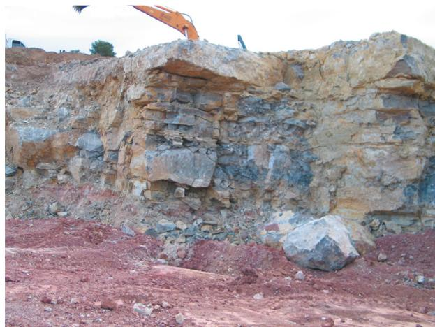
Photographie 5 : front rocheux disloqué en blocs, bassin minier de Villeveyrac
