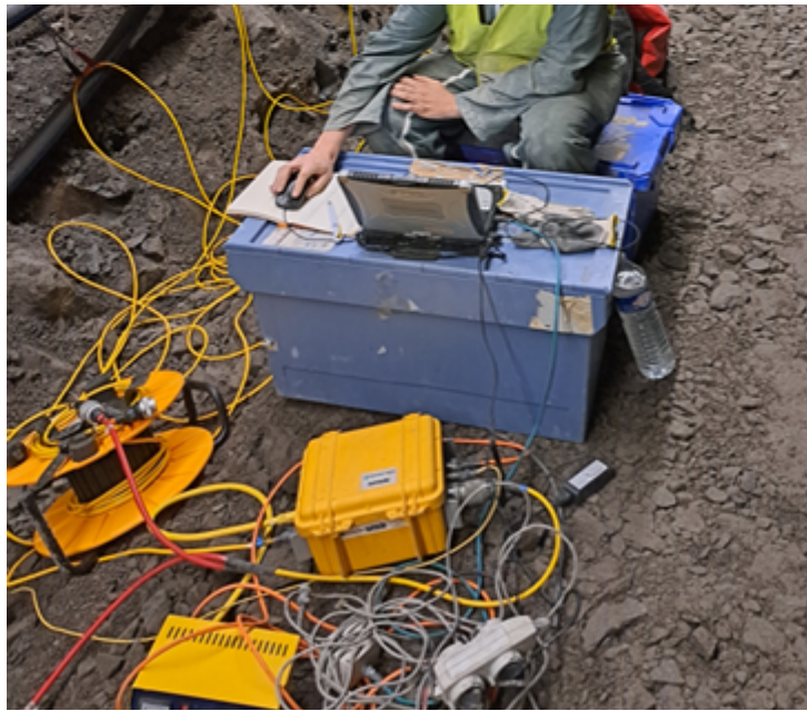
Figure 6 : Système d'acquisition sismique (géode et PC de contrôle).
