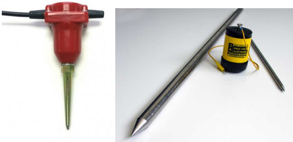
Figure 9 : Capteur sismique géophone (à gauche), et électrode (à droite).
