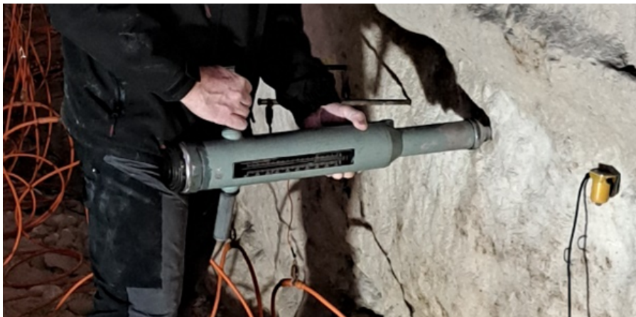
Figure 10 : Marteau de Schmidt en place sur un point source utilisé pour l'acquisition de la tomographie sismique.
