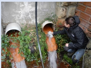
Prélèvement d'eau de mine en vue de l'analyse de son contenu en gaz dissous : crédit : Ineris
