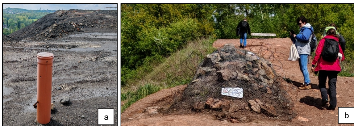
Figure 26 : Mesures de surveillance et de restrictions d'accès en République Tchèque en 2024 (a : monitoring en sondage de la zone en combustion ; b : Grillage et barbelés pour sécuriser une zone thermiquement active sur le teril d'Ema)
