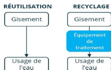
Schéma de principe différence réutilisation/ recyclage
