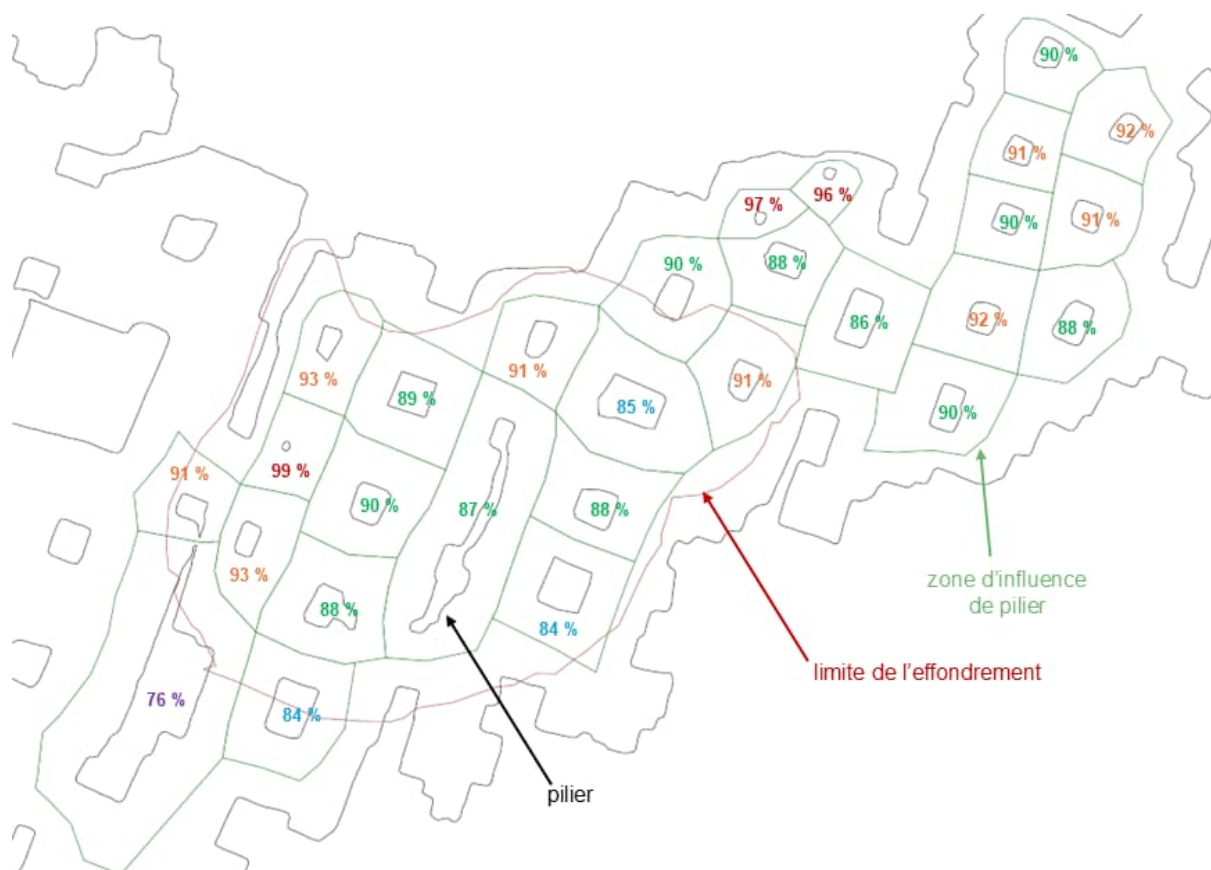
Figure 9 : Distribution du taux de défrètement au voisinage de la zone effondrée.
