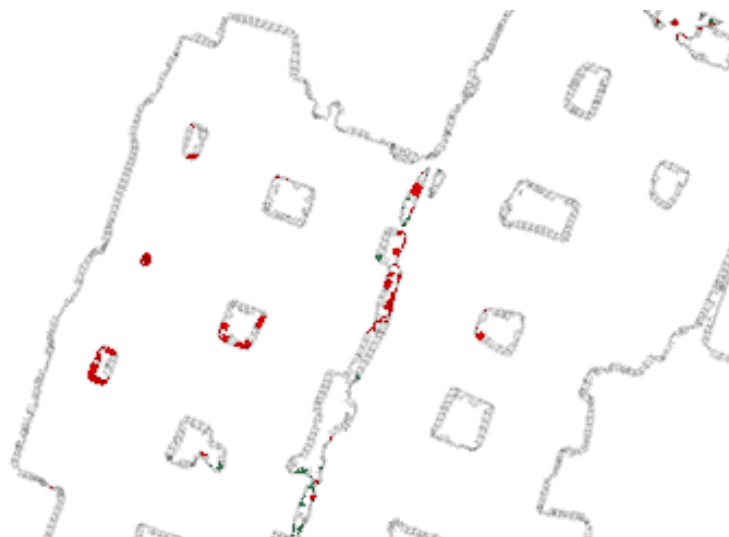
Figure 20 : Distribution de la plasticité, plan de coupe subhorizontal traversant les piliers de la carrière.
