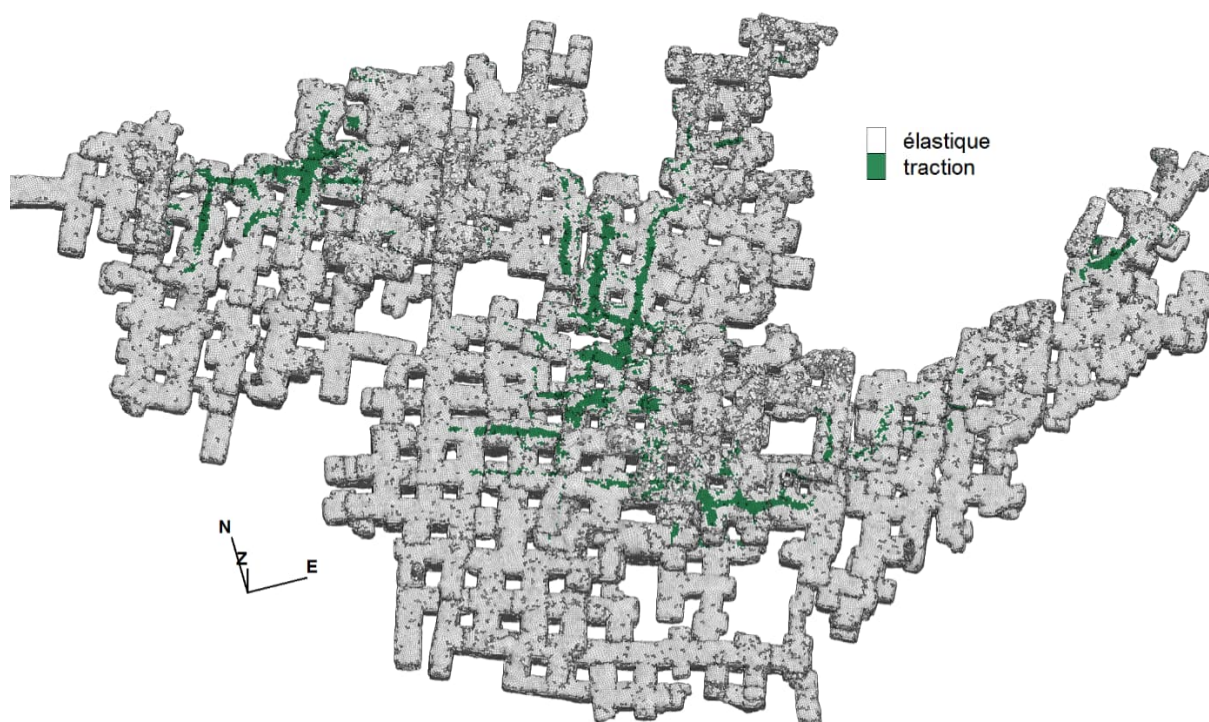
Figure 21 : Distribution de la plasticité en traction, atteinte au toit des galeries de la carrière.
