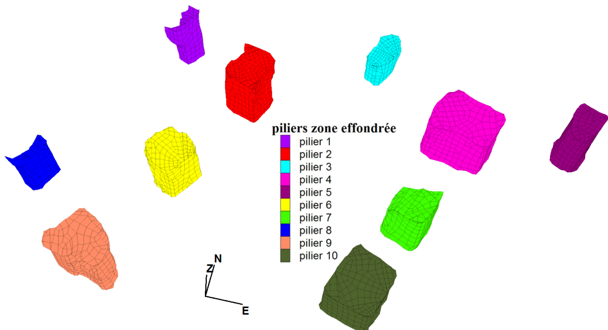
Figure 15 : Constitution des 10 groupes de mailles relatives aux piliers dans la zone effondrée.
