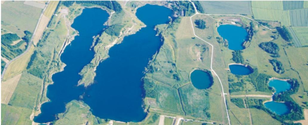
Figure 8 : Visualisation du résultat en surface des effondrements « contrôlés » des salins d'Haraucourt en Meurthe et Moselle (54) © Maison du sel
