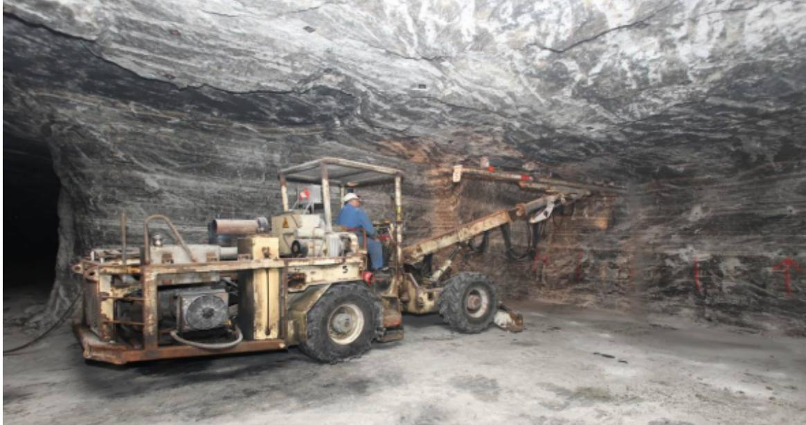
Figure 2 : Exploitation en chambres et piliers dans la mine de sel de Varangéville (Meurthe et Moselle)
