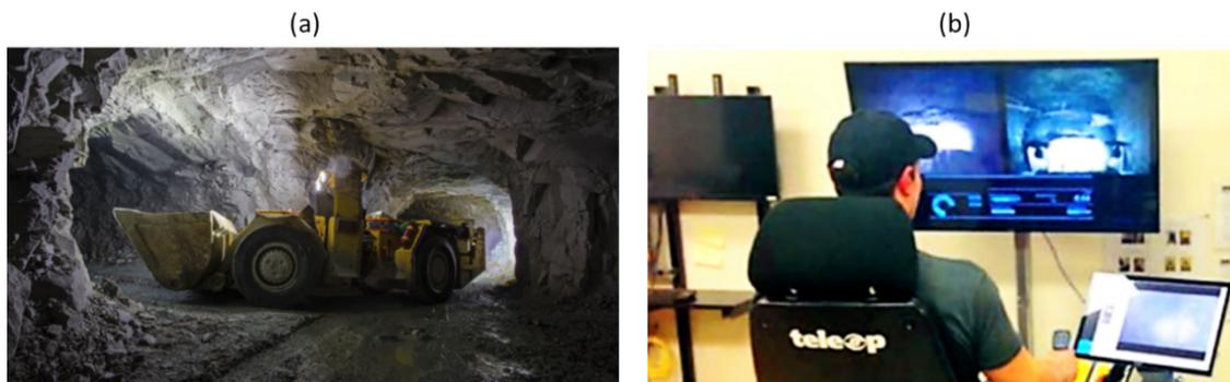
Figures 16 : a) Navigation d'un camion automatique de chargement, transport et déchargement dans une mine souterraine complexe via une opération à distance, b) Opérateur contrôlant le camion souterrain depuis la surface ©TeleOp Multi
