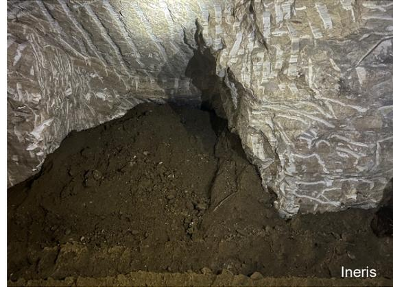
Figure 11 : Front de remblayage au sein de la carrière de gypse de Montmorency (95)
