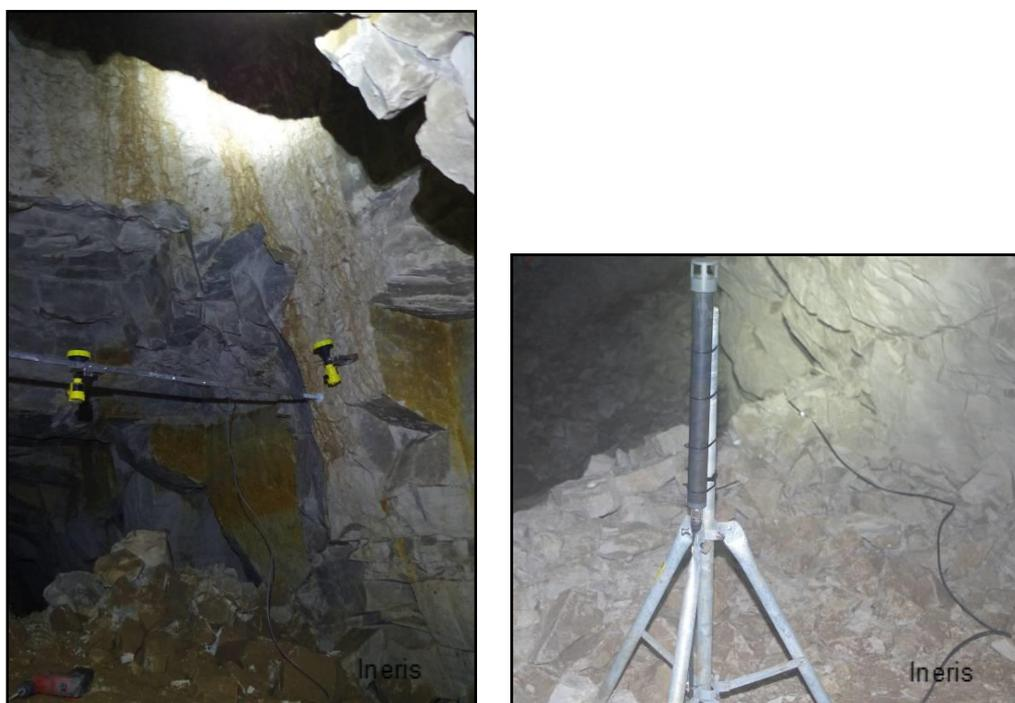
Figure 13 : Systèmes radar et microphone installés respectivement sous et à côté d'un puits de catiche
