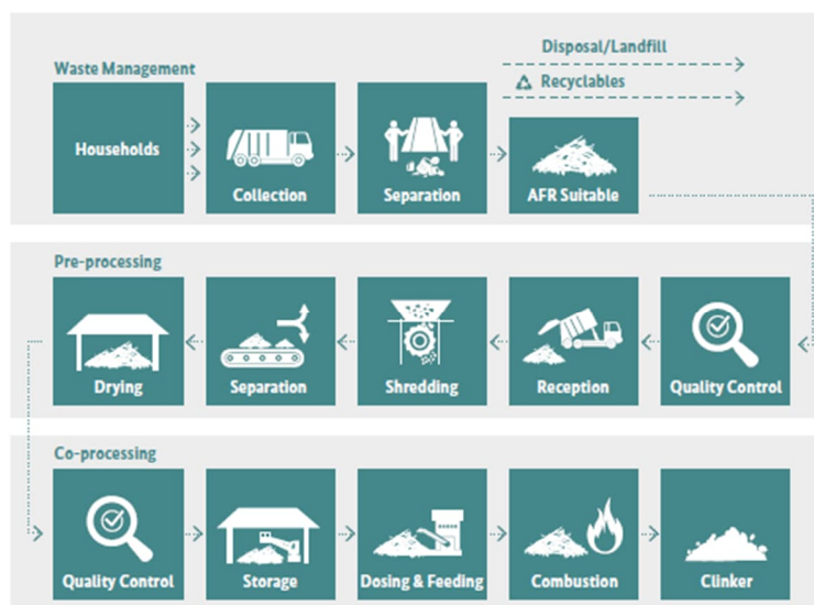
Figure 13 : Intégration des déchets municipaux dans le fonctionnement des cimenteries [Blume et al. (2020)].
