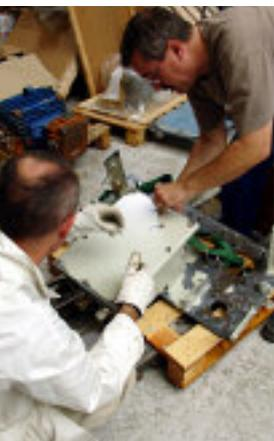
**Vérification d'un coffret après essai de détermination des degrés de protection IP.**
