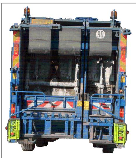
*Figure 1 : exemple de benne bi-compartmentée, vue arrière (l'accès aux deux compartiments se fait par l'arrière) ; document Suez*
