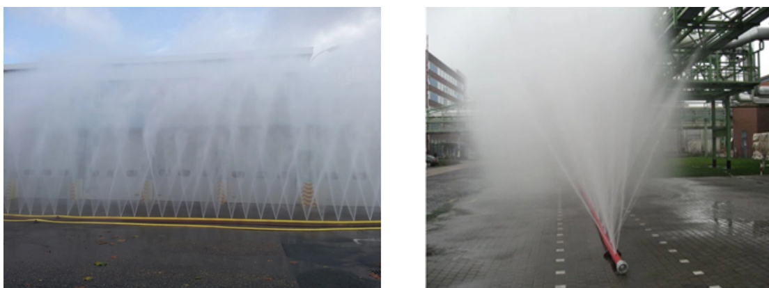
Figure 2. Exemples de rideaux d'eau déployés manuellement
