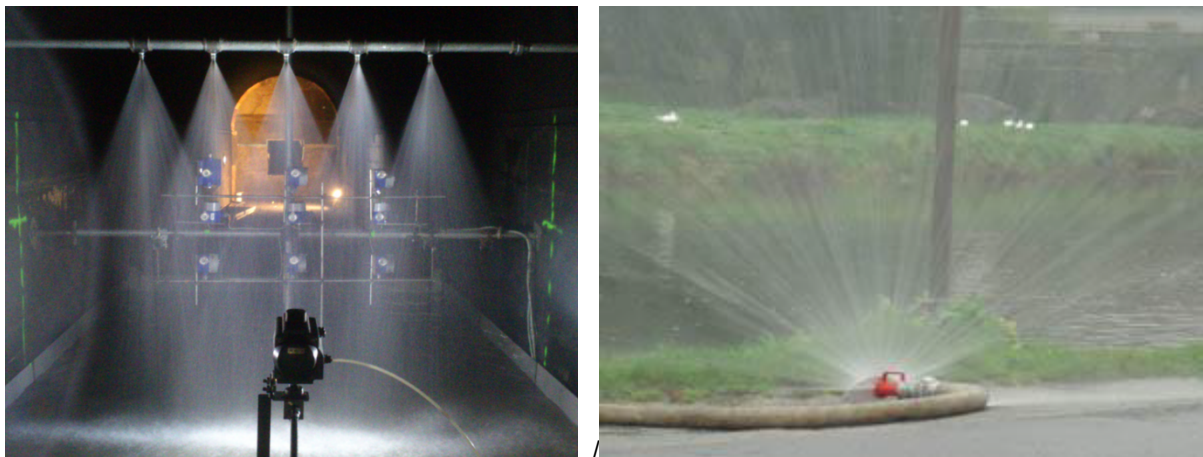
Figure 4. Exemples de rideaux d'eau « simples » : à gauche, rideau d'eau descendant (source : Ineris) ; à droite, lance « queue de paon » (source : IFP Training)
