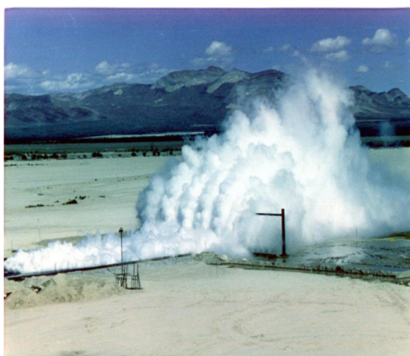
Figure 3. Effet d'un rideau d'eau ascendant sur un nuage de HF – campagne expérimentale Goldfish 1986 (Koopman, 2016)
