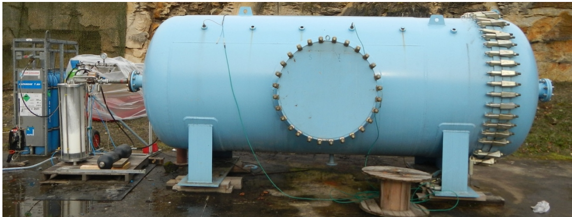
Figure 5 : Cuve d'explosion de 10 m 3 de l'Ineris
