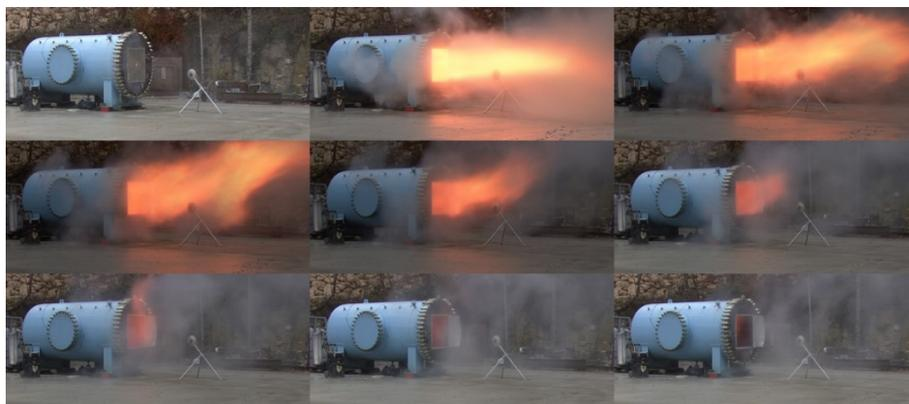
Figure 6 : Images de la décharge d'une explosion de poussières d'amidon de maïs par un événement d'explosion standard. La cuve est de volume 10 m<sup>3</sup> et l'événement de dimensions 1,1 x 1,1 m (400 ms entre les images).
