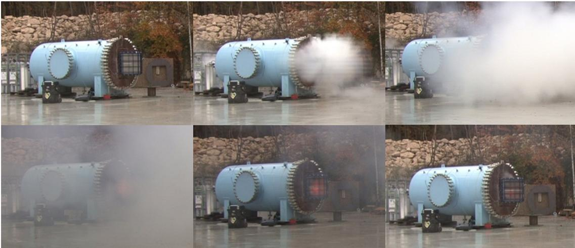
Figure 14 : Images capturées par une caméra HD standard lors de l'essai d'un dispositif pare-flamme de dimensions 350 x 650 mm avec 300 g/m<sup>3</sup> d'amidon de maïs dans une cuve de 10 m<sup>3</sup>
