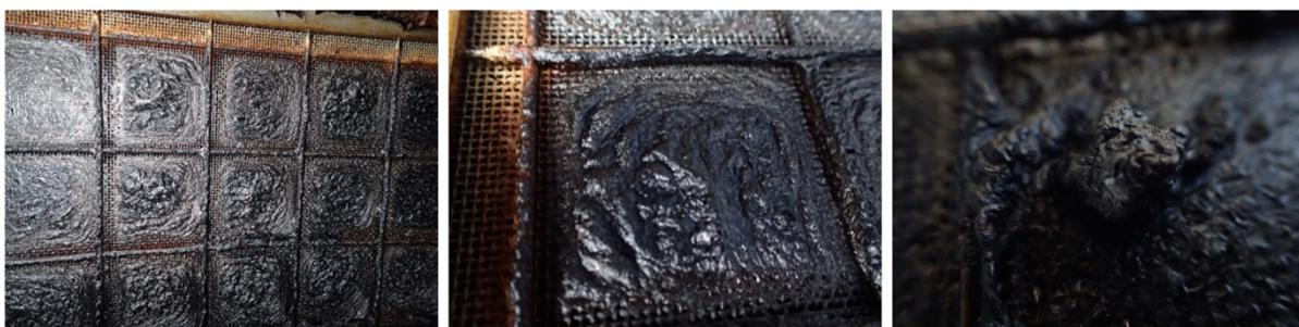
Figure 10 : Dépôt de poussières d'amidon de maïs observé sur la partie intérieure du filtre après un essai d'événement pare flamme
