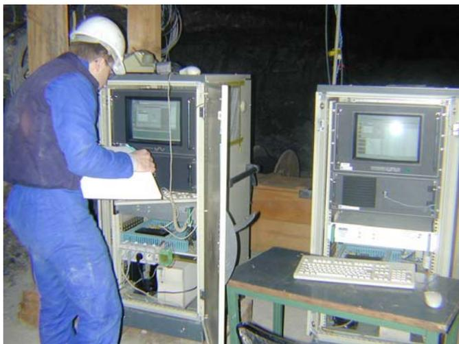
Figure 24 : Centrale d'acquisition automatique (carrière de gypse du Jura)
