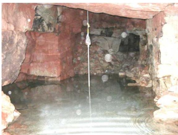
Figure 19 : Surveillance d'une carrière du Nord avec des relevés d'indices sur les parties peintes et des mesures de convergence
