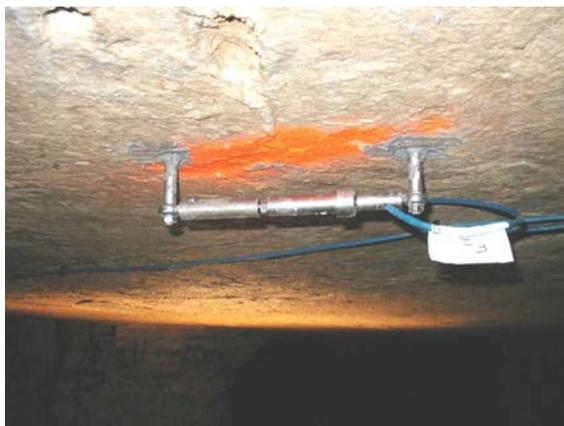
Figure 22 : Surveillance par télémesure à partir d'un fissuromètre
