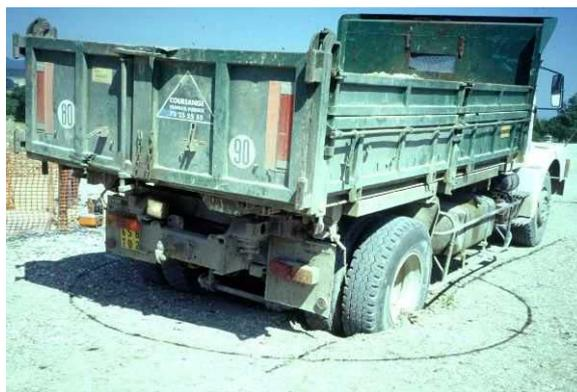
Figure 63 : Essai d'une membrane géotextile par un camion passant à l'aplomb d'un vide (photo projet RAFAEL, source société BIDIM)
