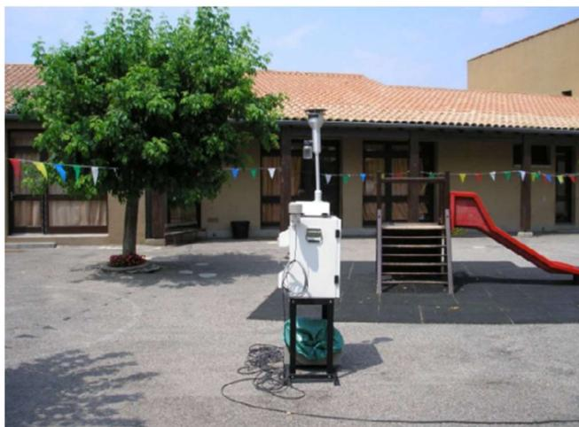
*Figure 10 : Préleveur sur filtres de particules en suspension*
