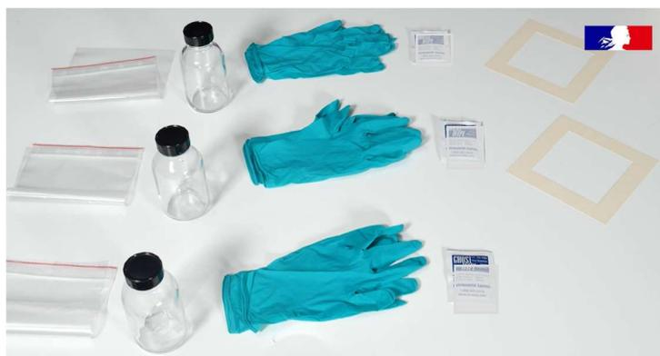
Figure A : Matériel nécessaire pour le prélèvement de suies
