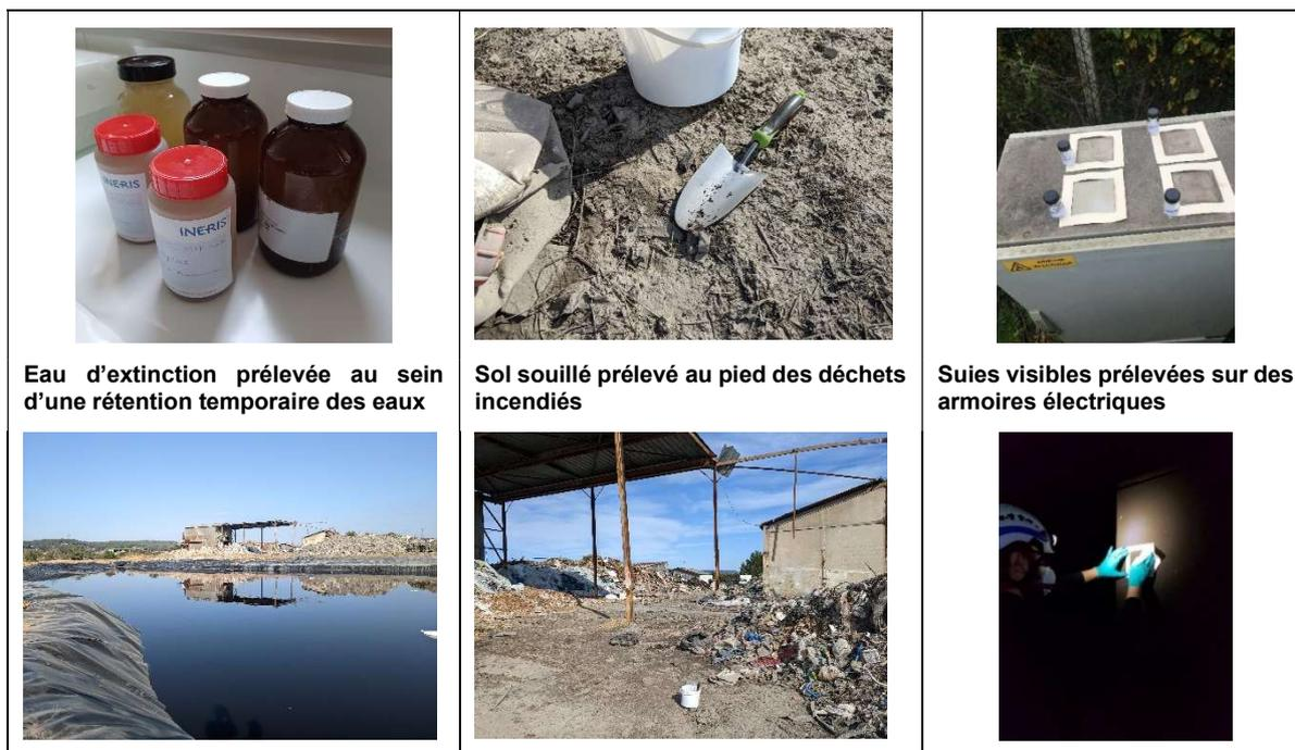
Figure 5 : Illustrations de prélèvements conservatoires immédiats : sols souillés, eaux d'extinction, suies visibles
