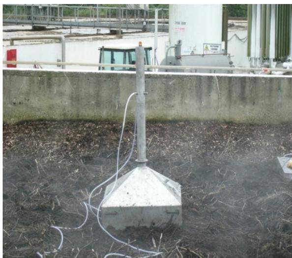
Les prélèvements d'air odorant sont réalisés directement sur la source (pour une source canalisée ou volumique) ou en sortie de chambre (à flux ou à cheminée).
