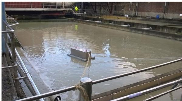
Photographie 3 : Exemple de chambre à cheminée pour les prélèvements d'odeurs sur des sources surfaciques solides actives
