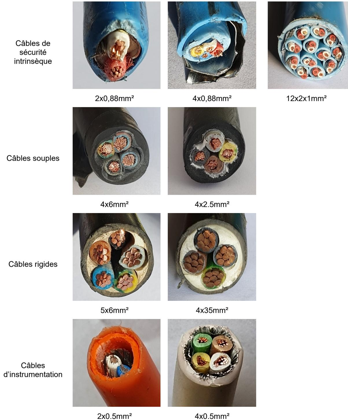
Figure 4 : Photos de l'ensemble des câbles multibrins testés
