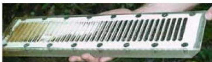
Figure 43 : En haut : capteur Peeper cylindrique en acrylique. En bas : capteur Peeper sous la forme de boîte percée
