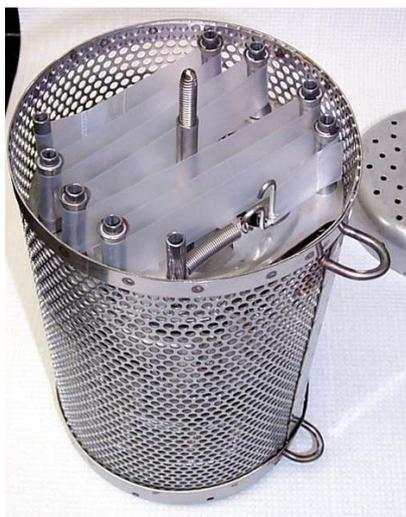
Figure 13 : Cage en acier inoxydable pour le déploiement du SPMD
