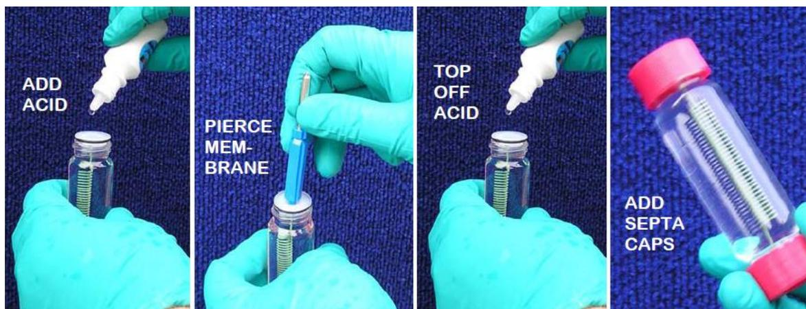
Figure 58 : Ajout d'un conservateur dans les bouteilles de prélèvement (ITRC, 2007)
