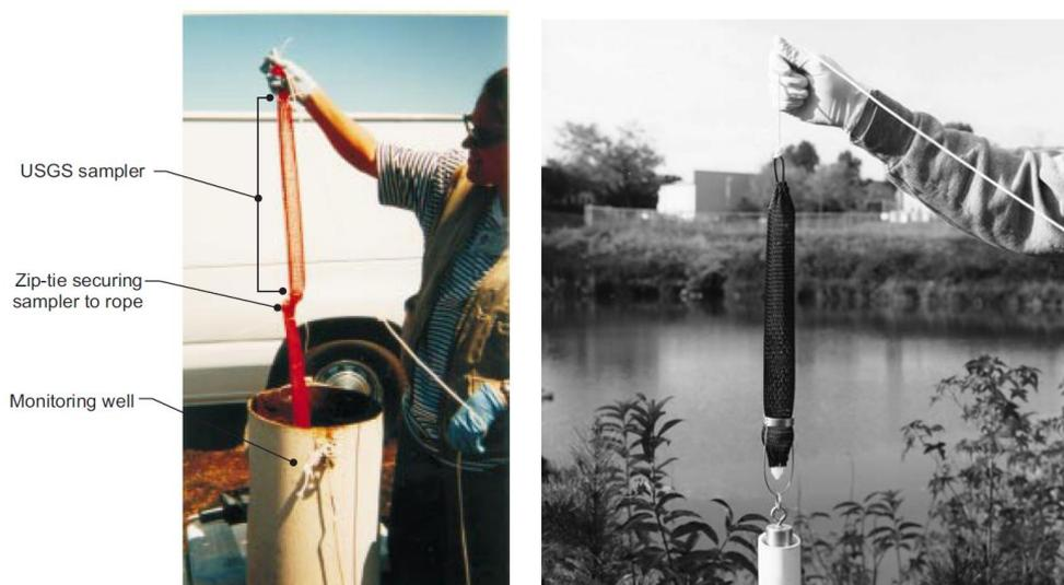
*Figure 35 : Installation d'un PDB.*
