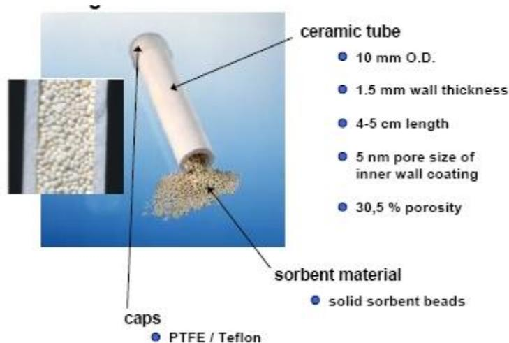
Figure 18 : Configuration et vue en coupe du dosimètre en céramique.
