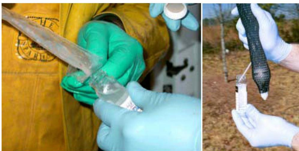
*Figure 36 : Transfert de l'échantillon dans des fioles pour analyse des COV.*
