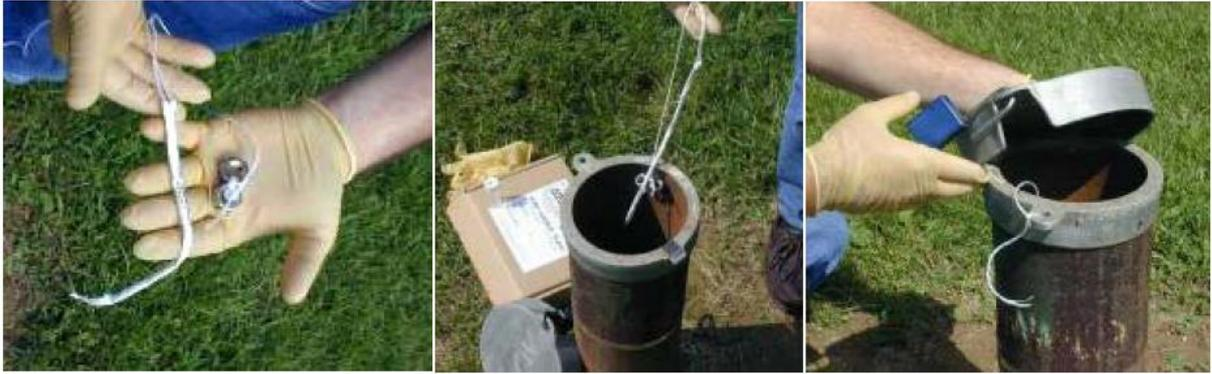
*Figure 27 : Mise en place d'un capteur de type Gore® Sorber Module.*
