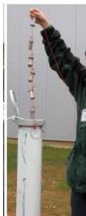
Figure 21 : Mise en place d'une série de dosimètres en céramique dans un puits de surveillance
