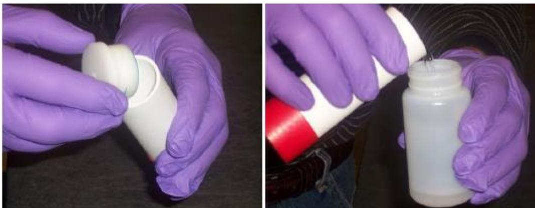
*Figure 40 : Transfert de l'échantillon du RPP dans le récipient de laboratoire*
