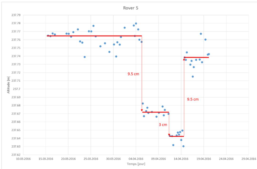
Figure 27 : Vue des déplacements enregistrés sur l'élévation du module GPS5
