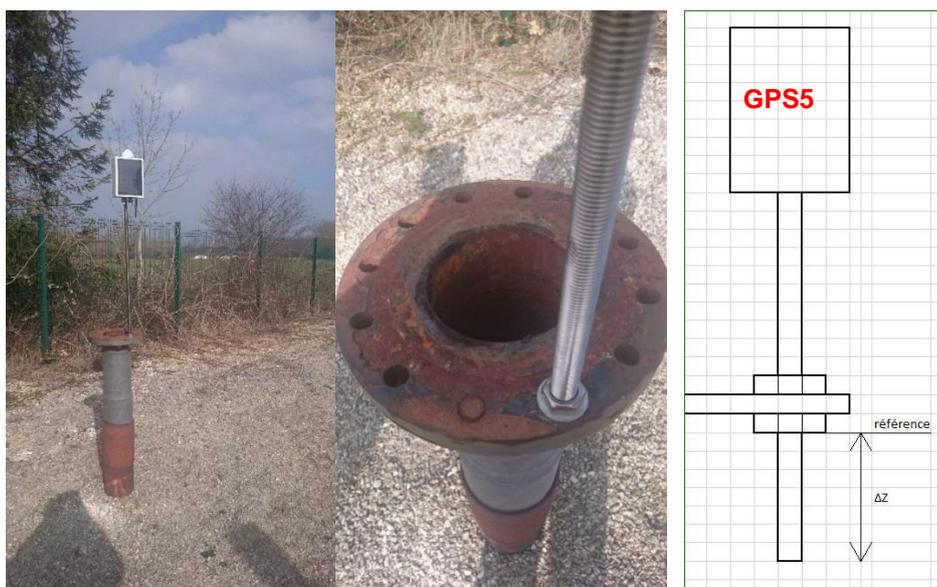
Figure 19 : Aperçus photos de l'implantation « test » du module GPS5 (à droite, principe schématique du test en coupe)
