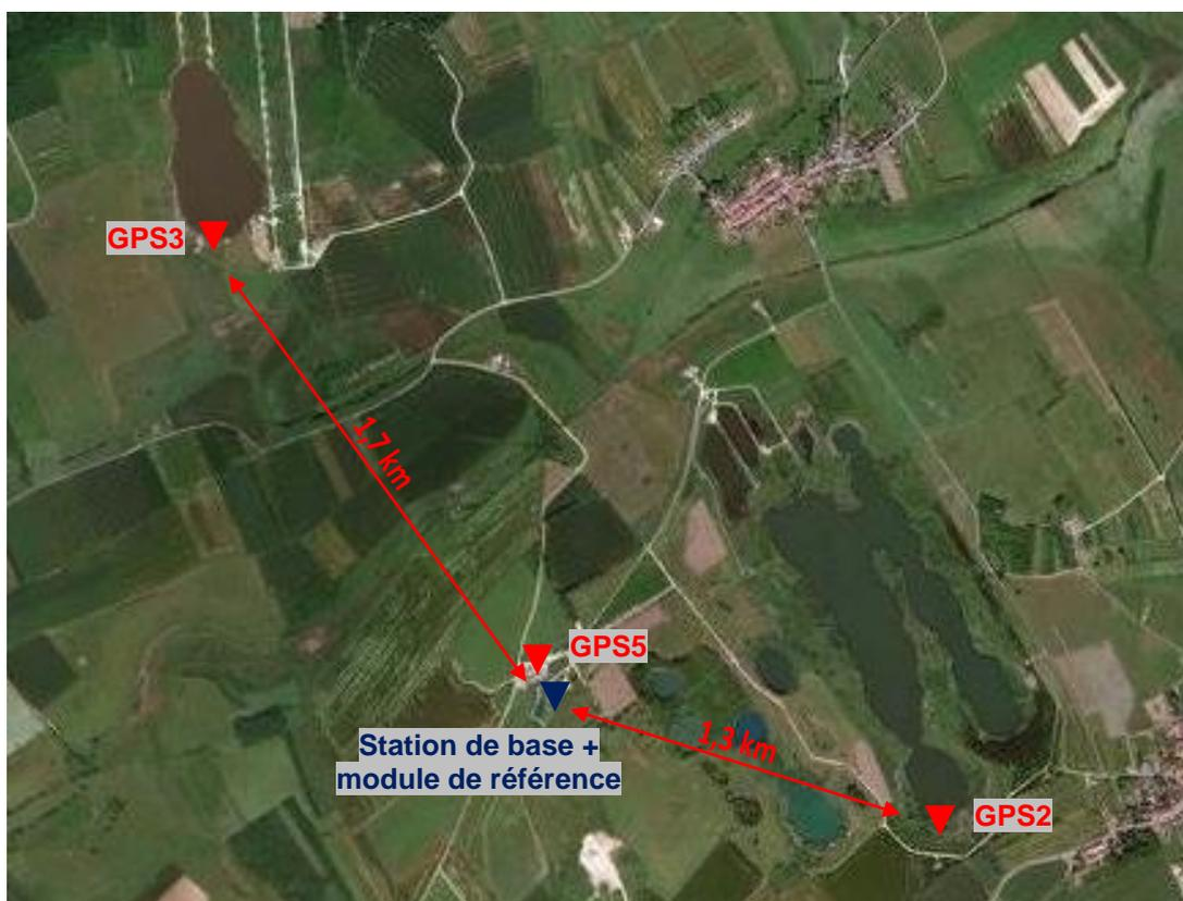
Figure 20 : Vue d'ensemble du dispositif testé
