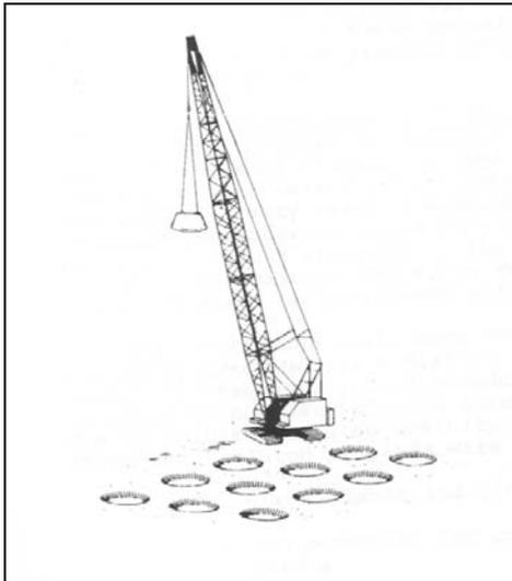
Figure 11 : Illustration de la technique de compaction dynamique (Guyot, 1984)
