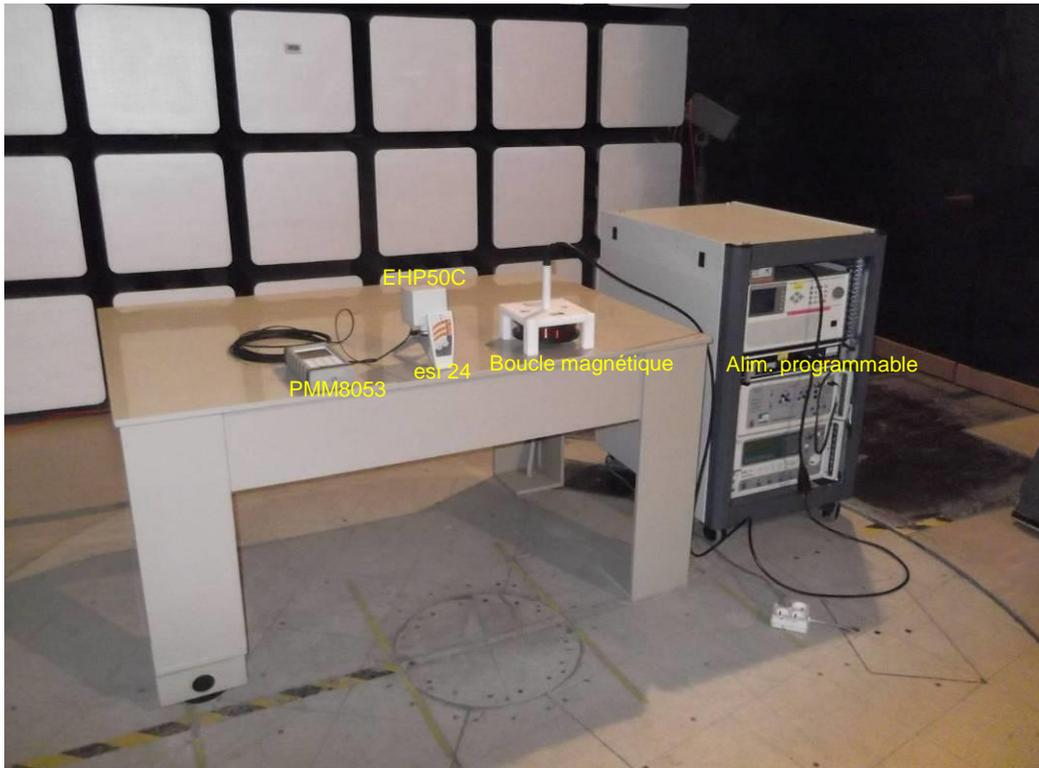
Photo 2 : ESI 24 – Matériels utilisés dans la chambre anéchoïque pour la mesure du champ magnétique BF
