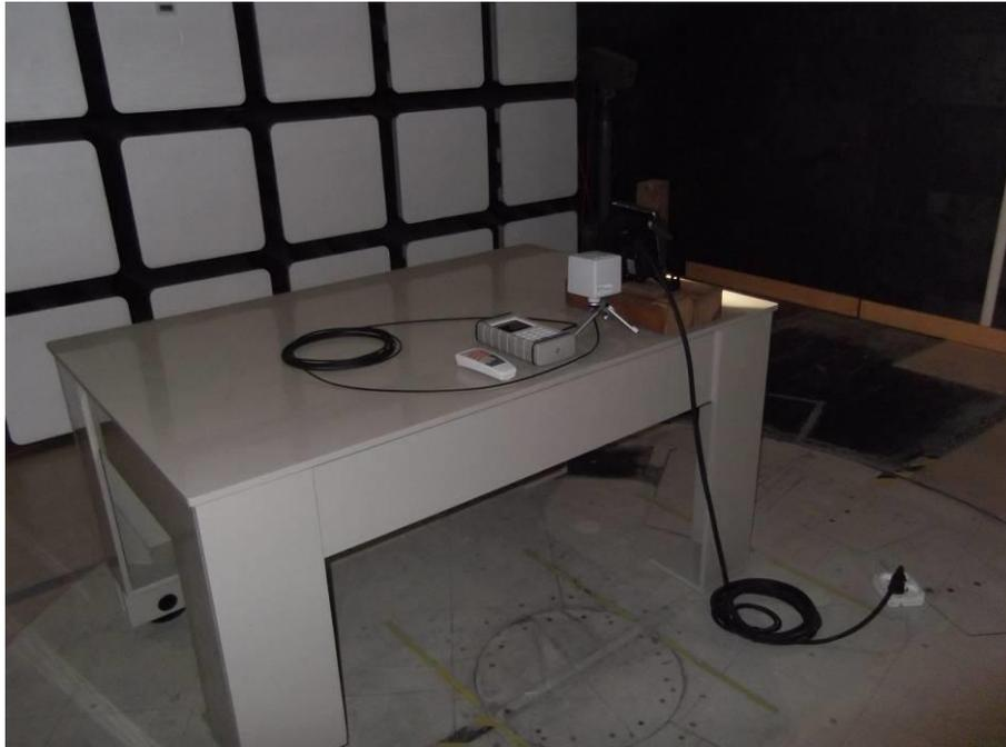
*Photo 3 : ESI 24 – Matériels utilisés dans la chambre anéchoïque pour la mesure du champ électrique BF*
