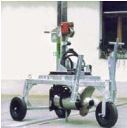
*Figure 4 : Brasseur propulseur avec vis de brassage réglable en hauteur (Source: Chambre d'agriculture Nouvelle-Calédonie)*
