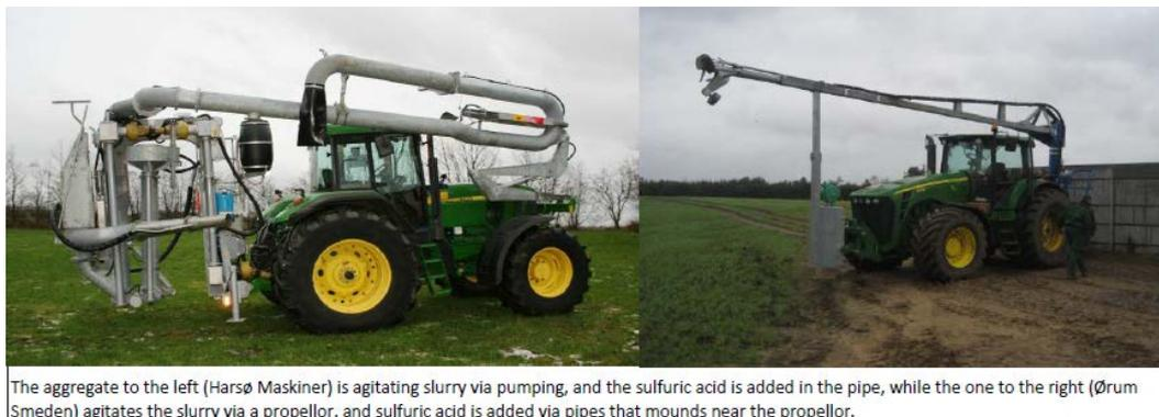
Figure 5 : Dispositif d'injection d'acide dans les ouvrages de stockage externes (Source :IPPC, 2017)
