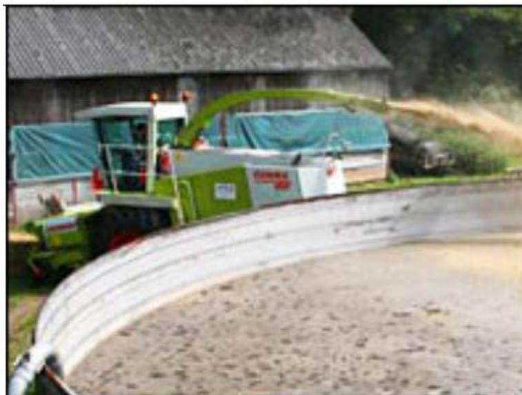
*Figure 8: Application d'une couche de paille à l'aide d'une moissonneuse batteuse
