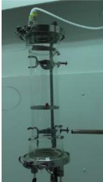
*Photographie 1 : Tube en verre destiné à la détermination des limites d'explosivité et de la CLO.*
