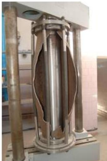
*Figure 1 : Rupture d'un tube soumis à de l'hydrogène (Projet Naturalhy) - Extrait du rapport final du contrat ENIM- Naturalhy*
