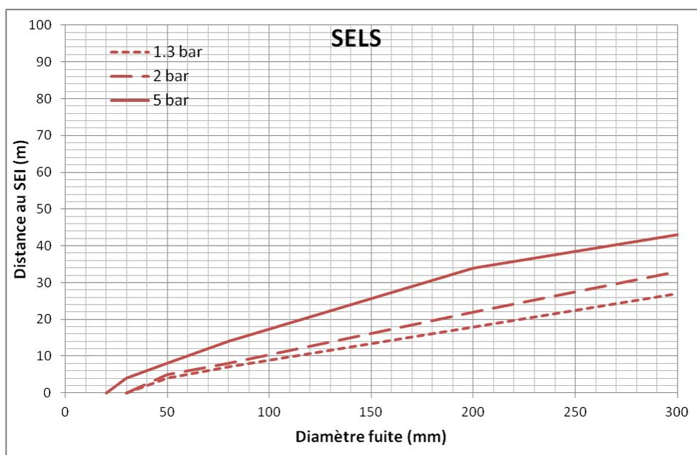
Figure 22 : Feu torche - Rejet vertical - Évolution de la distance au SELS en fonction du diamètre de fuite pour 3 pressions : 1.3, 2 et 5 bar absolus
