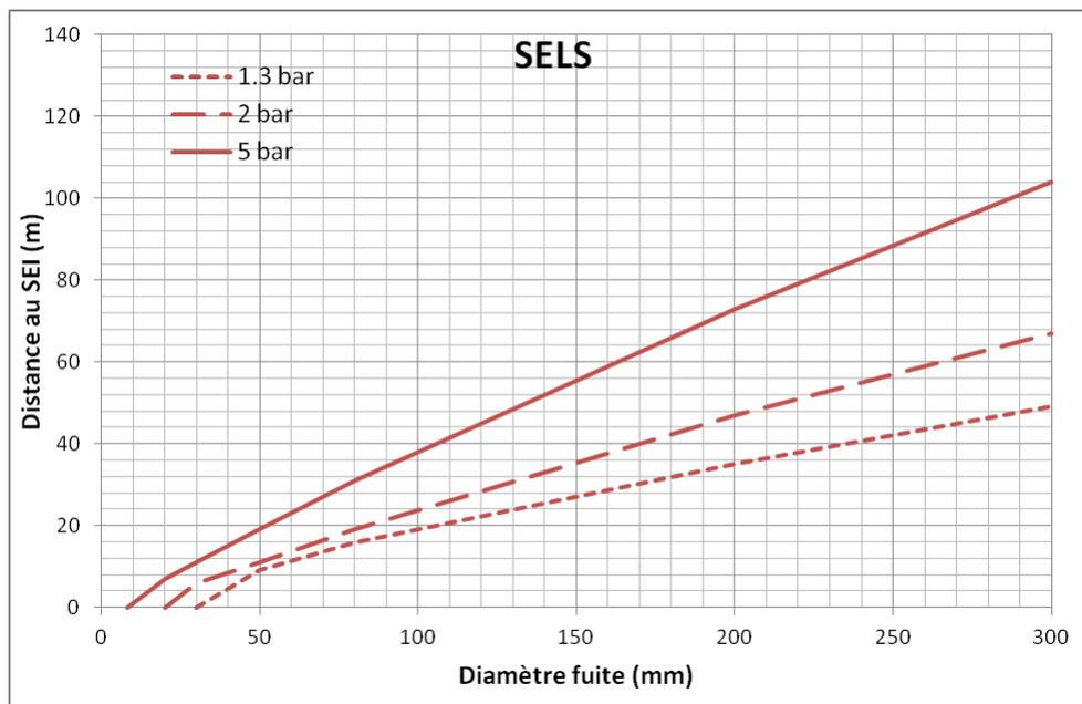
Figure 19 : Feu torche - Rejet horizontal - Évolution de la distance au SELS en fonction du diamètre de fuite pour 3 pressions : 1.3, 2 et 5 bar absolus
