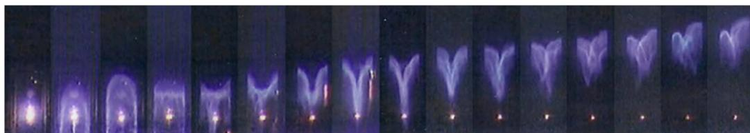
Figure 30 : Formation d'une flamme « tulipe » dans un tube vertical de section 10 x 10 cm avec un mélange méthane-air à 5,9 % ; 20 ms entre les images ; le point rouge visible en bas est le point d'inflammation. (Proust, 2004)
