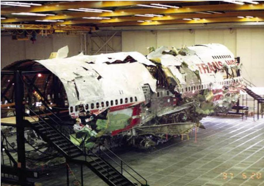
Figure 3 : Reconstitution du fuselage de l'avion après l'accident
