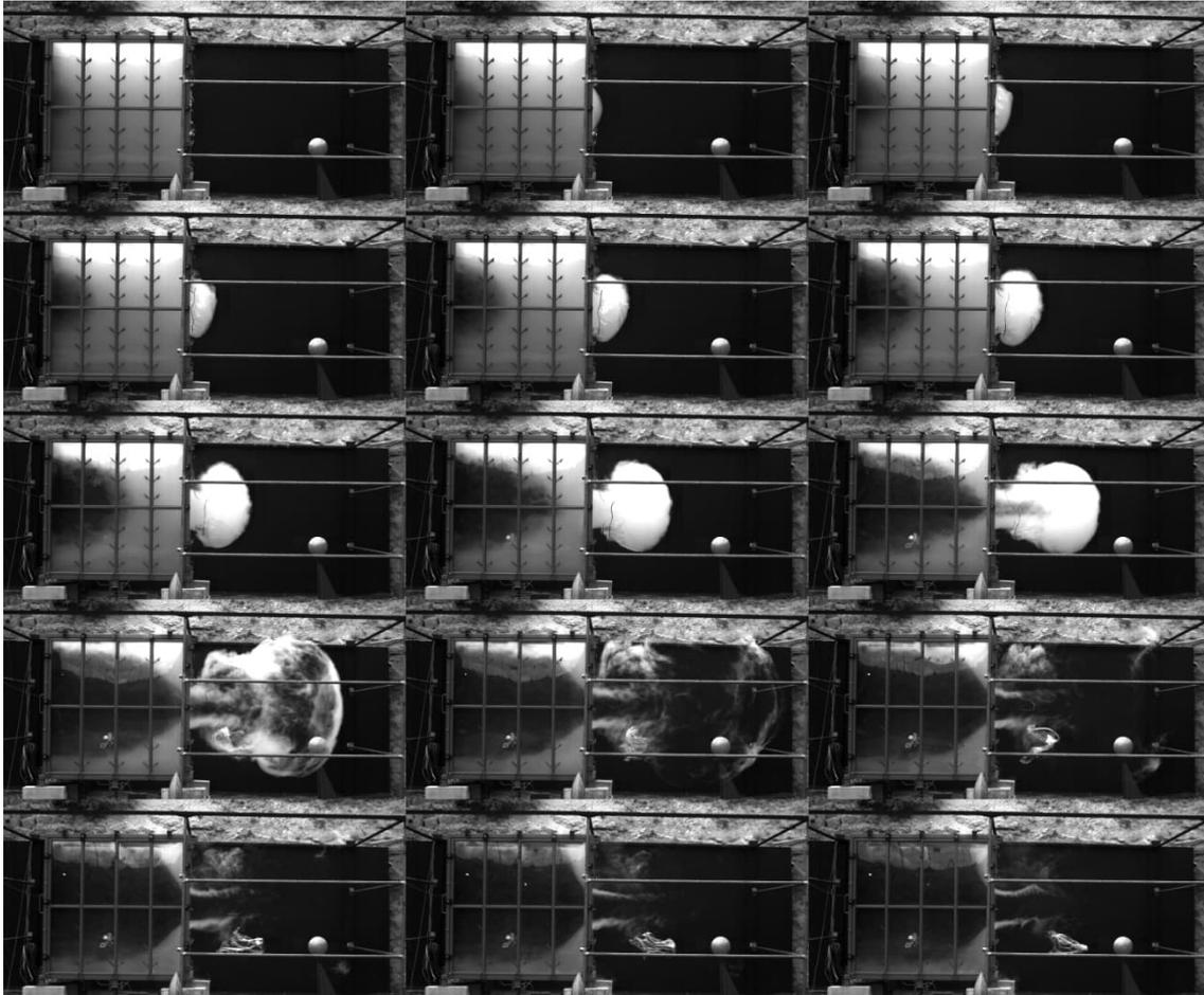
Figure 24 : Exemple d'explosion secondaire (mélange hydrogène air concentré à 15 %, cuve de 4 m<sup>3</sup> et événement de 0.5 m<sup>2</sup>, 10 ms entre 2 images)
