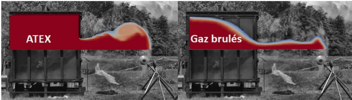
Figure 43 : Position du nuage et de la flamme au moment où elle atteint le bord du nuage (ATEX fait ici référence au nuage explosif complet : l'ensemble des espèces chimiques réactives et brûlées)
